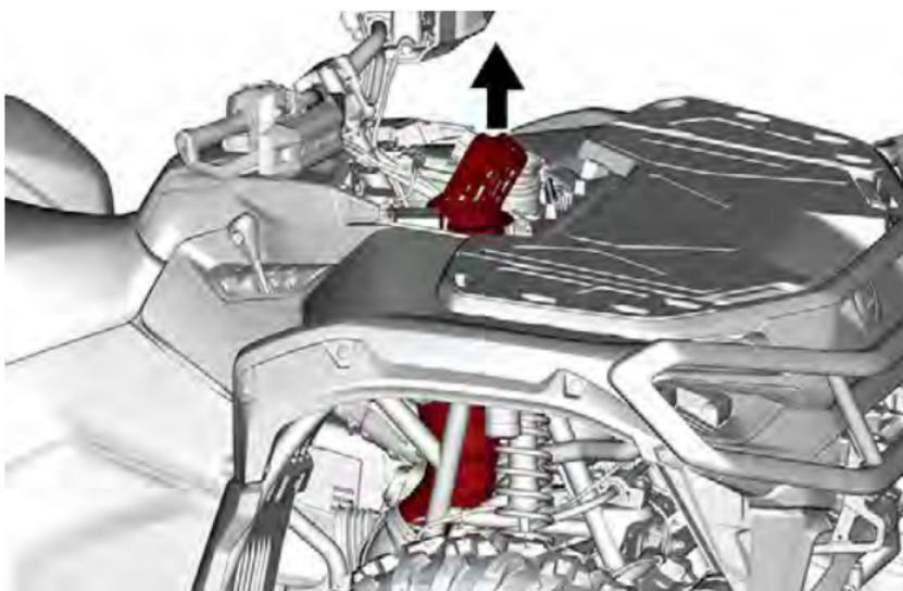
5. Remova o parafuso da braçadeira do fio da bobina.
