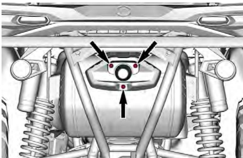
2. Remova a guarnição do escapamento.
