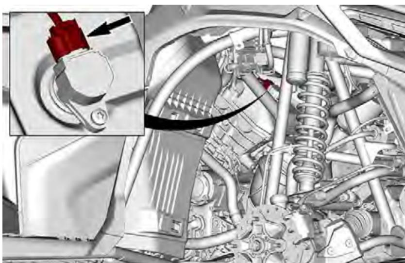
7. Remova o parafuso de retenção da bobina de ignição.
