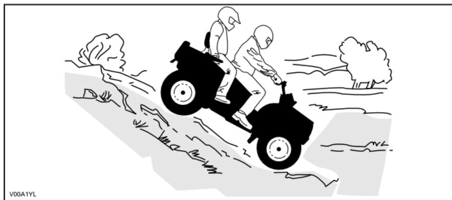
Manter o peso do corpo para trás. Fique sentado. Use o freio gradualmente para evitar derrapar. Não “desça” a inclinação em ponto morto ou usando apenas o freio motor.
