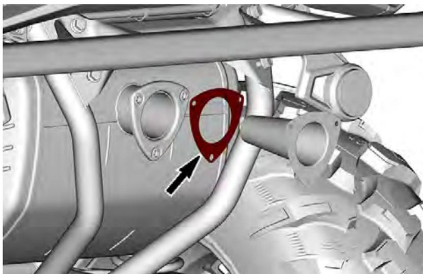
9. Instale a guarnição do escapamento.
