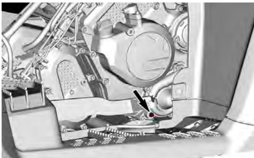
3. Para finalizar o esvaziamento completo do sistema de arrefecimento, desconecte a mangueira inferior do radiador da tampa da bomba de água e drene o líquido de arrefecimento restante em um recipiente apropriado. Descarte a braçadeira Oetiker.
