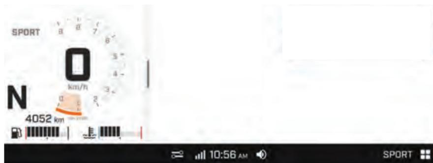
Na exibição estreita, pressione longamente o medidor de percurso para mostrar um dos itens a seguir. Use pressionamentos longos adicionais para percorrer os itens.
