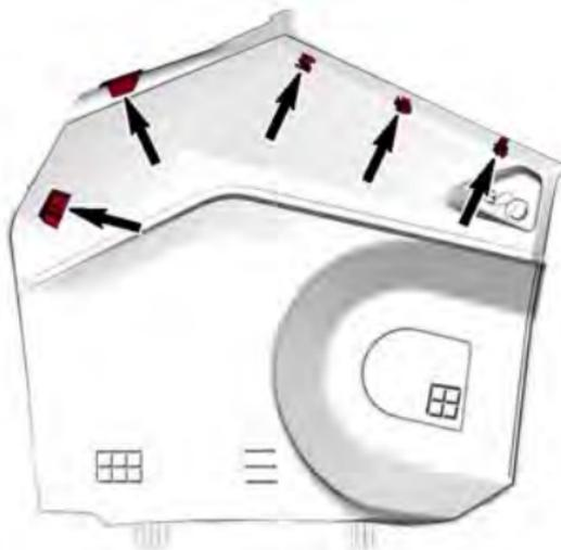
4. Incline o painel lateral exterior do veículo e puxe para cima para removê-lo do veículo.
