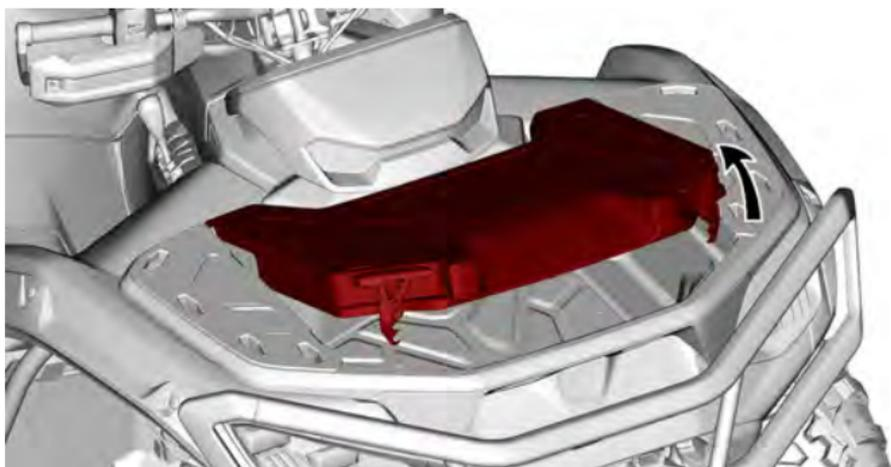
2. Gire a alavanca localizada dentro do compartimento de armazenamento para travar a tampa na posição aberta.
