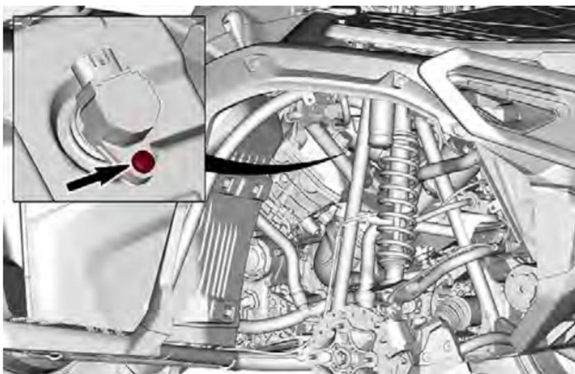
8. Retire a bobina de ignição.
