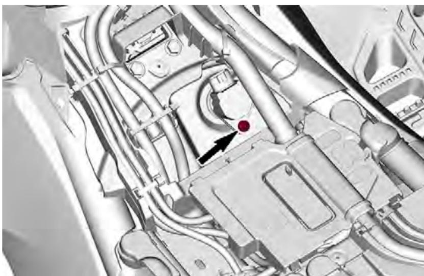
6. Retire a bobina de ignição.
