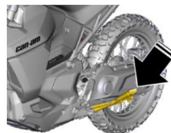
Estabilice el vehículo en posición vertical utilizando el caballete. Asegúrese de que el pie del caballete descansa sobre una superficie dura.
