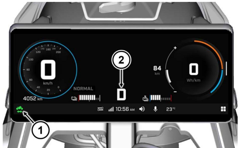
**Haute tension activée et système de propulsion activé**
