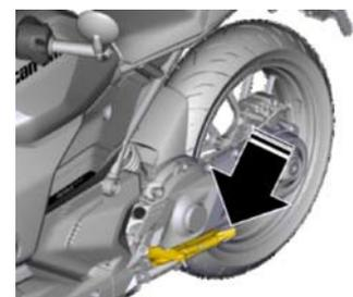
Stabilisieren Sie das Fahrzeug in der angehobenen Position mit dem Ständer. Stellen Sie sicher, dass der Ständerfuß auf einer harten Oberfläche steht.
