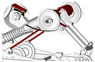
SPRING PRELOAD ADJUSTMENT LH — TYPICAL
