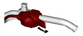
THUMB THROTTLE POSITION : PUSH DOWNWARD TO ROTATE THROTTLE HOUSING
