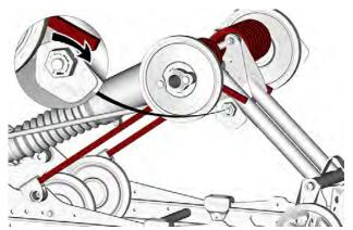
SPRING PRELOAD ADJUSTMENT LH — TYPICAL
