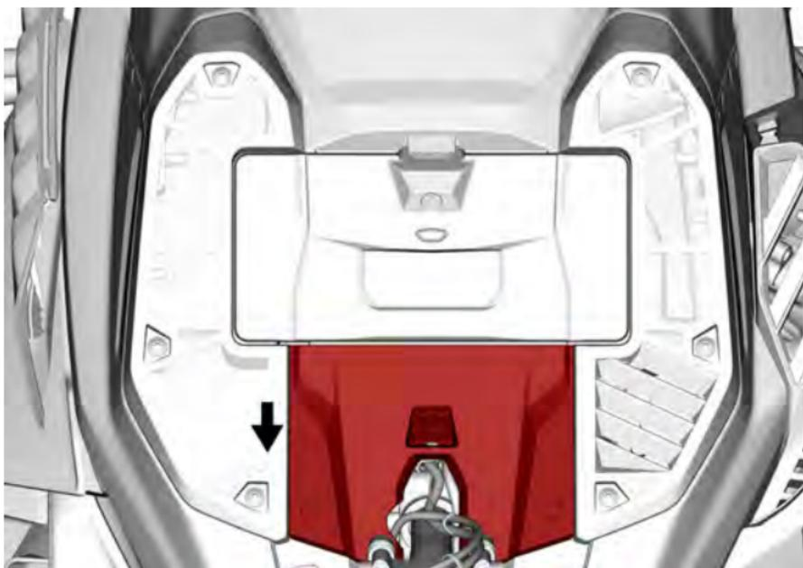
2. Vérifiez le niveau de liquide de refroidissement à la température ambiante. Le liquide doit toucher la surface plate de la lunette.
