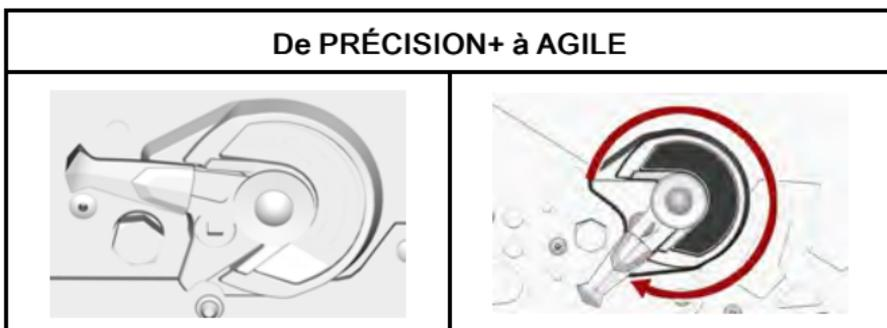
En usine, la sangle d'arrêt réglable est réglée de manière à ce que la position « AGILE » corresponde au réglage n° 4 de la sangle d'arrêt ordinaire. La position « PRÉCISION+ » = réglage N° 7 sur la sangle d'arrêt ordinaire.
