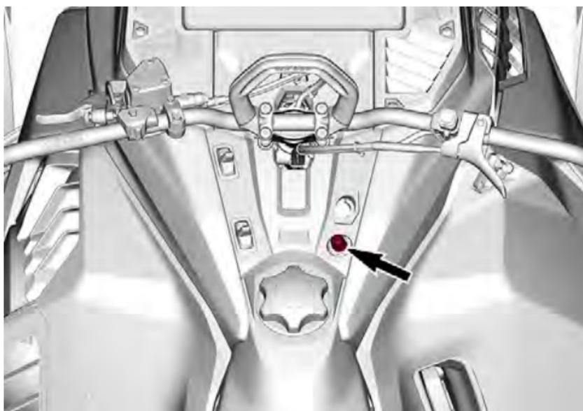
Le commutateur de coupure du moteur (cordon coupe-circuit) est situé sur la console.
