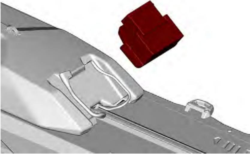
3. Installez le support de fixation de la batterie. Fixez-le à l'aide de la vis et des rondelles plates retirées précédemment.
