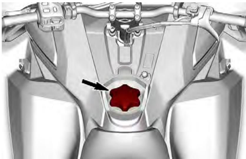
4. Insérez le bec dans le goulot de remplissage.
