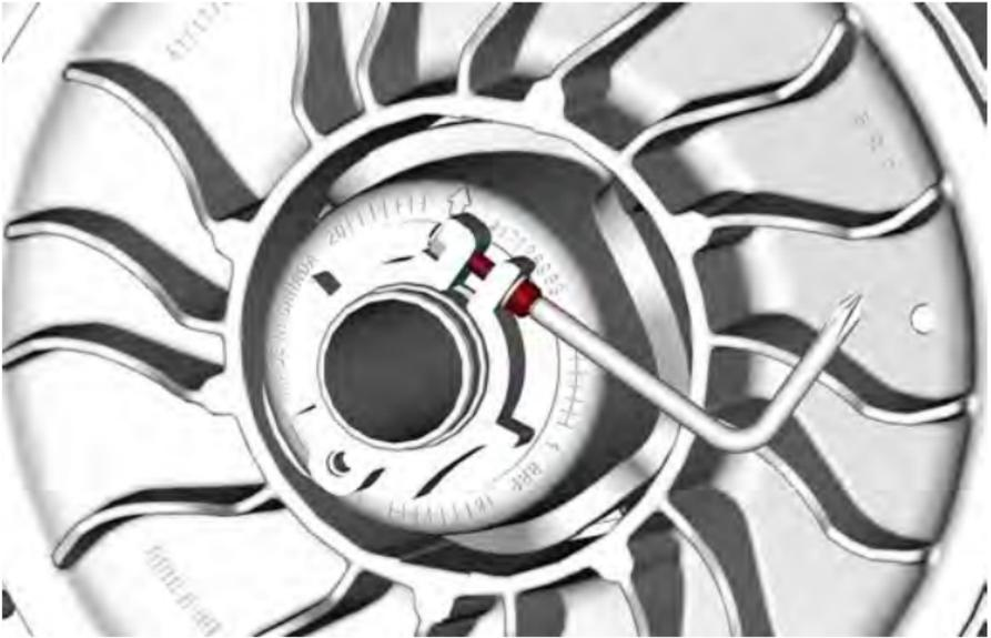
6. Avec l'outil de réglage de la suspension fourni dans la trousse à outils, tournez la bague de réglage d'un seul quart de tour à la fois. Tournez la poulie entraînée pour positionner précisément la courroie entre les flasques de la poulie.
