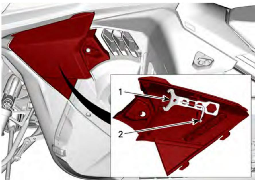
1. *Strumento di regolazione delle sospensioni*
