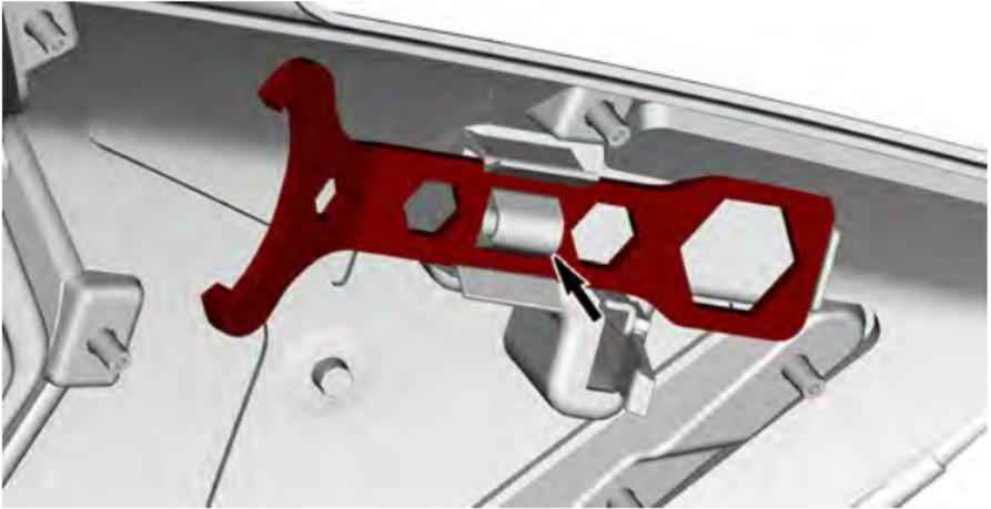
2. Far scorrere il dispositivo di espansione della puleggia e l'estremità lungo dello strumento di regolazione fari nel foro.
