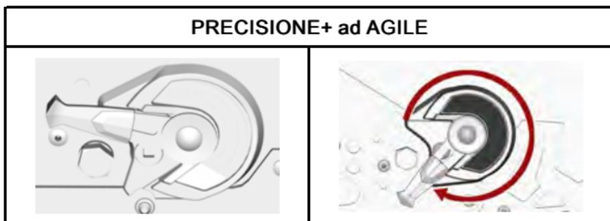
La cinghia di fermo regolabile è impostata di fabbrica in modo tale che la posizione "AGILE" = impostazione #4 sulla cinghia di fermo regolare. La posizione "PRECISIONE" = impostazione #7 sulla cinghia di fermo regolare.
