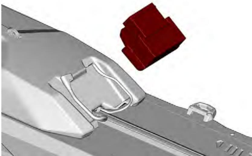
3. Installare la staffa di serraggio della batteria. Fissare con la vite rimossa in precedenza e con la rondella piatta.
