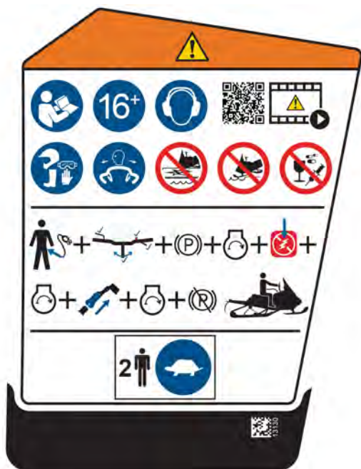
始動手順 - 警告ラベル
