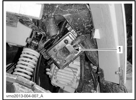
1. Soupape d'injection d'air
