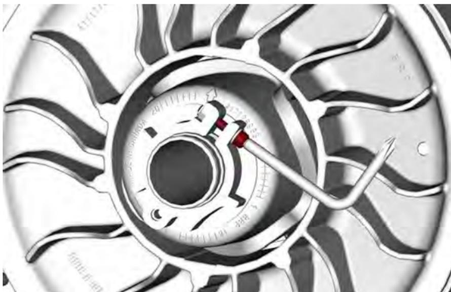
5. Drehen Sie den Einstellring mit der im Werkzeugsatz enthaltenen Vorrichtung zur Einstellung der Aufhängung jeweils um eine Viertelumdrehung und drehen Sie dann die Abtriebsscheibe, damit der Riemen zwischen den Scheiben den richtigen Sitz findet.
