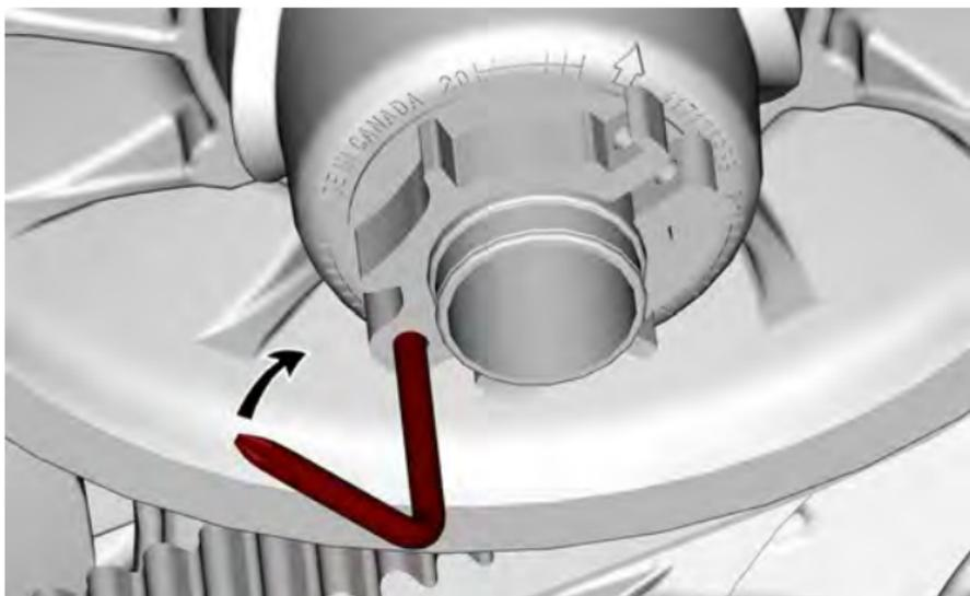
4. Öffnen Sie die Abtriebsscheibe, indem Sie das Werkzeug hineindrehen.
