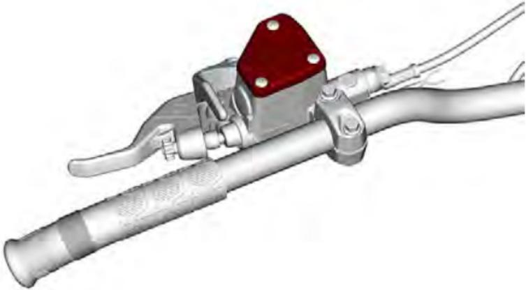
2. Entfernen Sie die Halteschrauben des Behälterdeckels.
