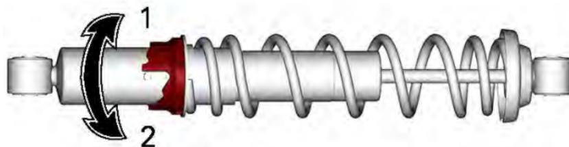
1. Vorspannung erhöhen
