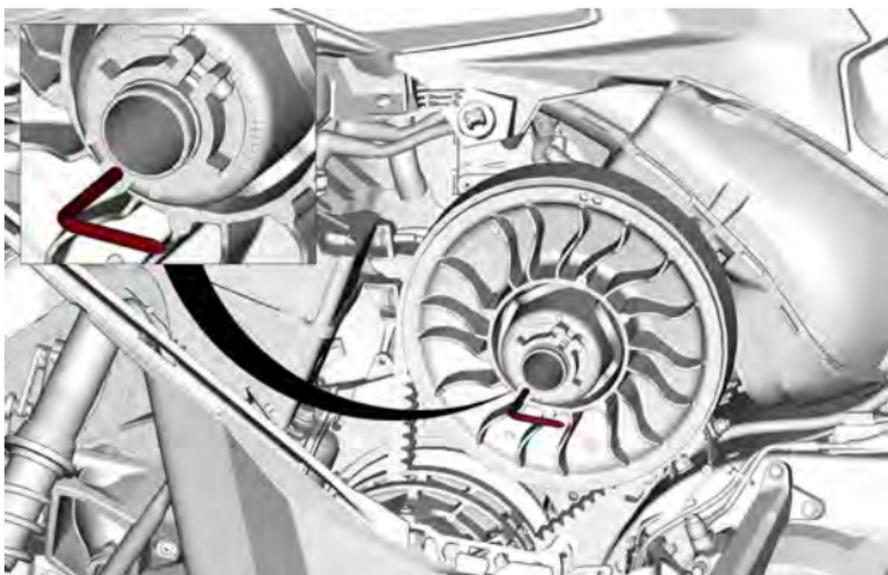
**TYPISCH - SCHEIBEN-EXPANDER AN NABE DER EINSTELLVORRICHTUNG MONTIERT**
