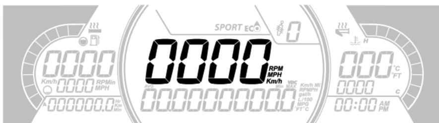
Anzeige der Fahrzeuggeschwindigkeit in km/h (oder mph) oder der Drehzahl in U/min. Siehe *Einstellungen*.
