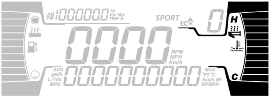
Die beheizten Griffe und der Gashebel sind ausgeschaltet, wenn keine Balken auf der Anzeige angezeigt werden.
