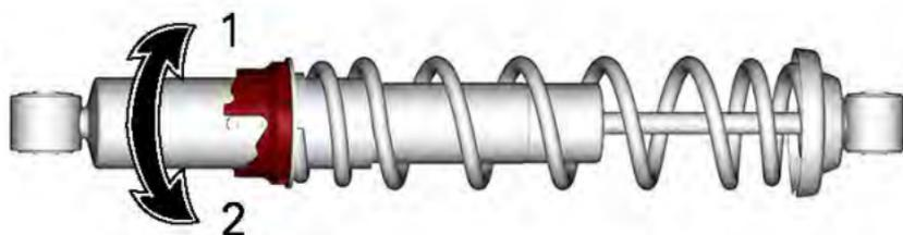
1. Vorspannung erhöhen
