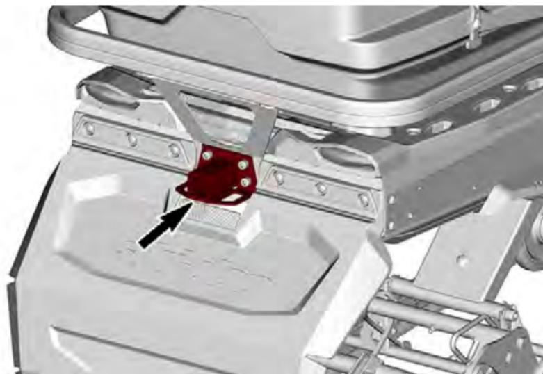
Verwenden Sie die Zugvorrichtung zusammen mit einer Abschleppstange, um ein Zubehörgerät abzuschleppen.
