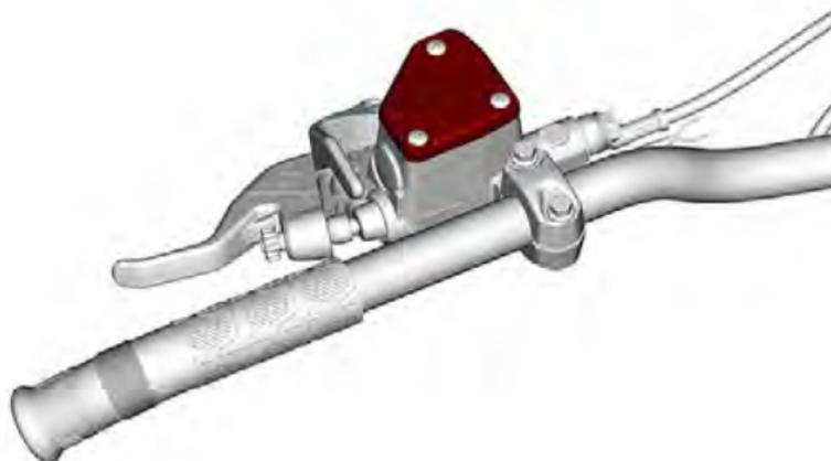
2. Entfernen Sie die Halteschrauben des Behälterdeckels.
