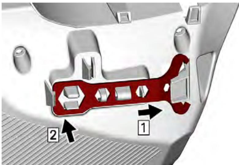
3. Schieben Sie den Scheiben-Expander und die Scheinwerferereinstellvorrichtung am kurzen Ende in das Loch.
