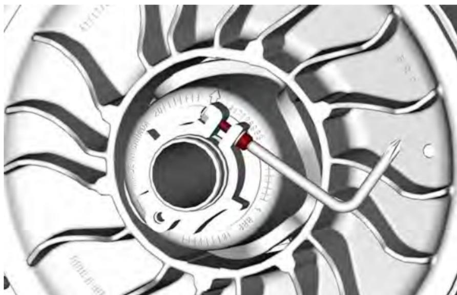
6. Drehen Sie den Einstellring mit der im Werkzeugsatz enthaltenen Vorrichtung zur Einstellung der Aufhängung jeweils um eine Viertelumdrehung und drehen Sie dann die Abtriebscheibe, damit der Riemen zwischen den Scheiben den richtigen Sitz findet.
