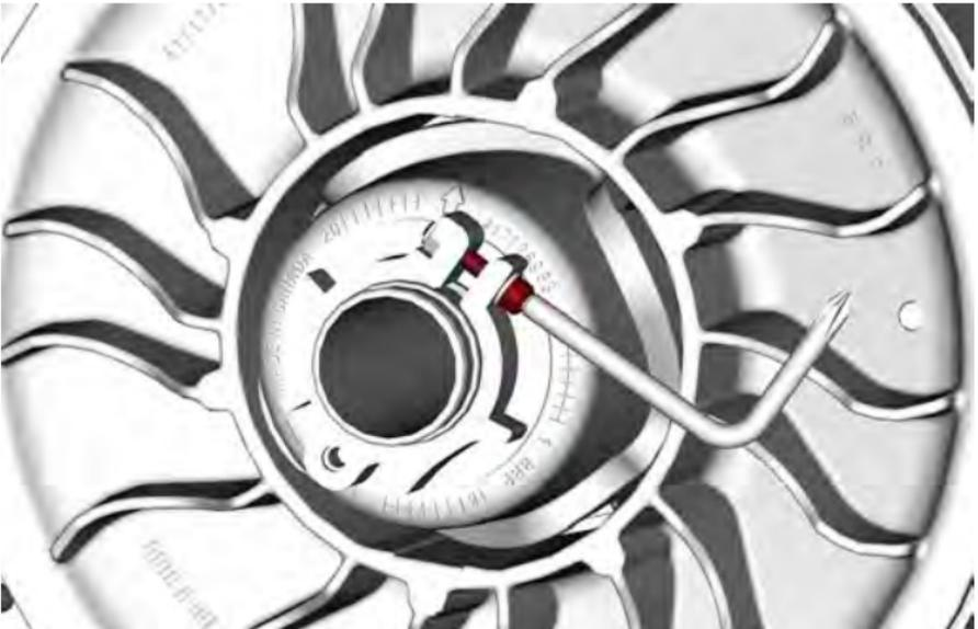
6. Drehen Sie den Einstellring mit der im Werkzeugsatz enthaltenen Vorrichtung zur Einstellung der Aufhängung jeweils um eine Viertelumdrehung und drehen Sie dann die Abtriebsscheibe, damit der Riemen zwischen den Scheiben den richtigen Sitz findet.
