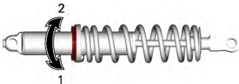
1. Vorspannung erhöhen
