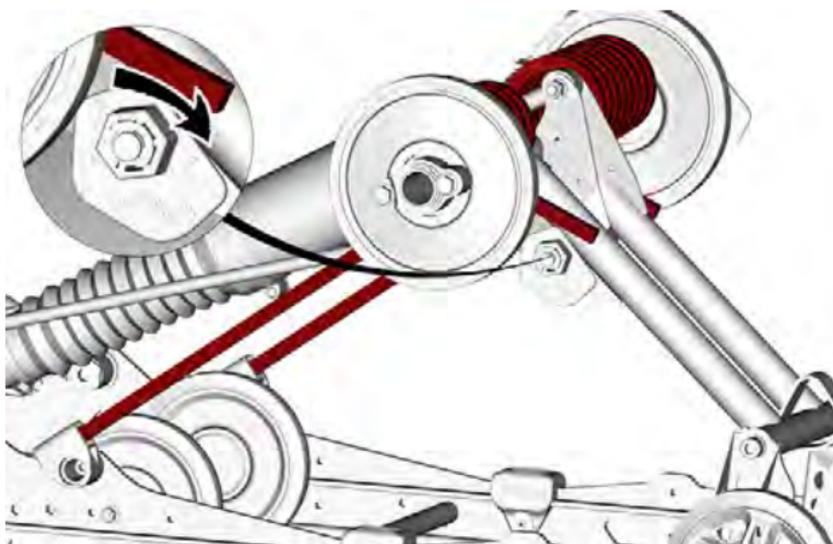
**EINSTELLUNG FEDERVORSPANNUNG LINKS – TYPISCH**
