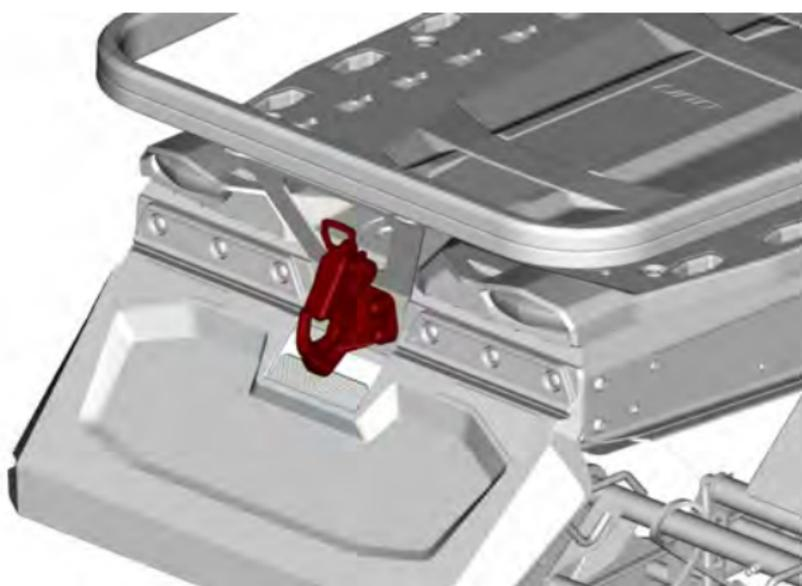
Um den Haken zu öffnen, drücken und drehen Sie den Griff, um die Verriegelungsplatte einzuziehen.
