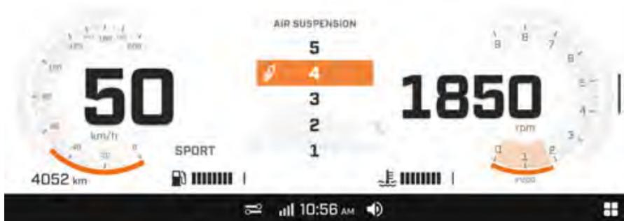
**Ändern Sie die Federungsstufe mithilfe der Fahreinstellungstaste**
