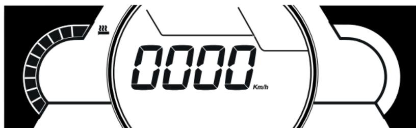
Die Einstellstufen des Gashebels werden über die Temperaturanzeige angezeigt und blinken bei Auswahl.
