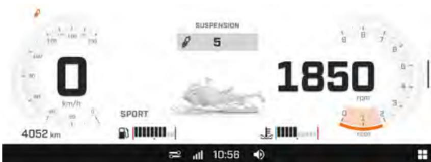
4. Verwenden Sie den Berührungsbildschirm oder die Pfeiltasten Nach oben/Nach unten des Multifunktionsschalters, um die Federungsstufe zu ändern.
