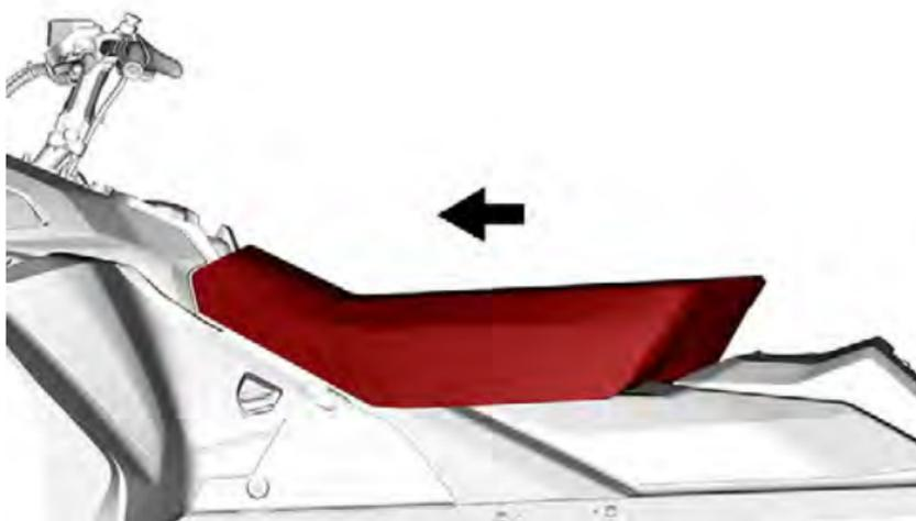
2. Beide Kugelzapfen an der Vorderseite sicher einrasten lassen.
