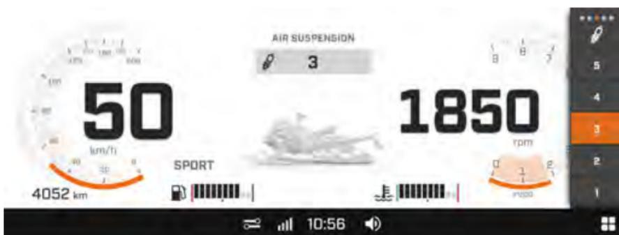
7. Verwenden Sie den Berührungsbildschirm oder die Pfeiltasten Nach oben/Nach unten des Multifunktionsschalters, um die Federungsstufe zu ändern.
