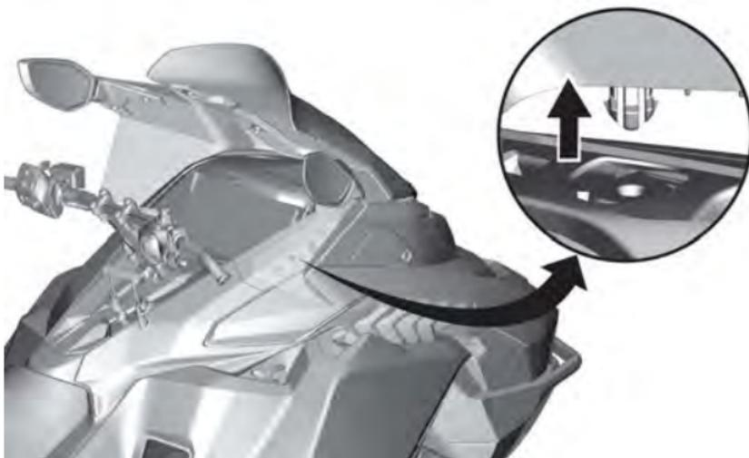
6. Ziehen Sie die Windschutzscheibe nach oben, bis sich beide mittleren Zapfen aus ihren Gummitüllen lösen.
