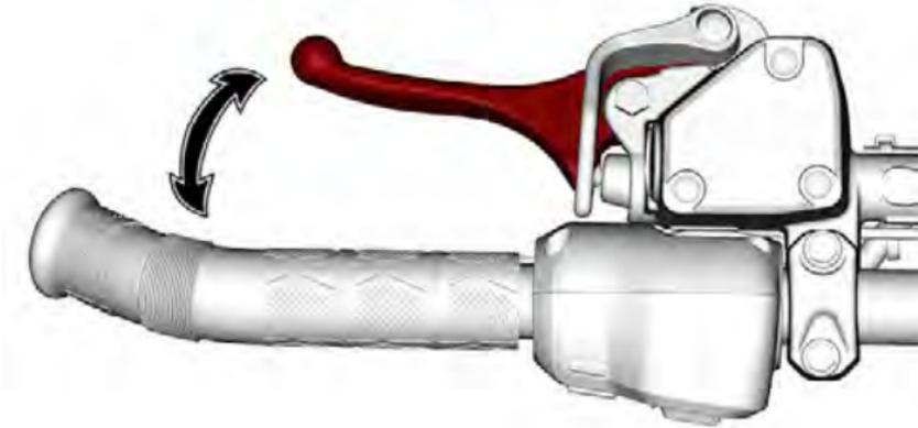
**TIPICO****Leva acceleratore regolabile (se in dotazione)**
