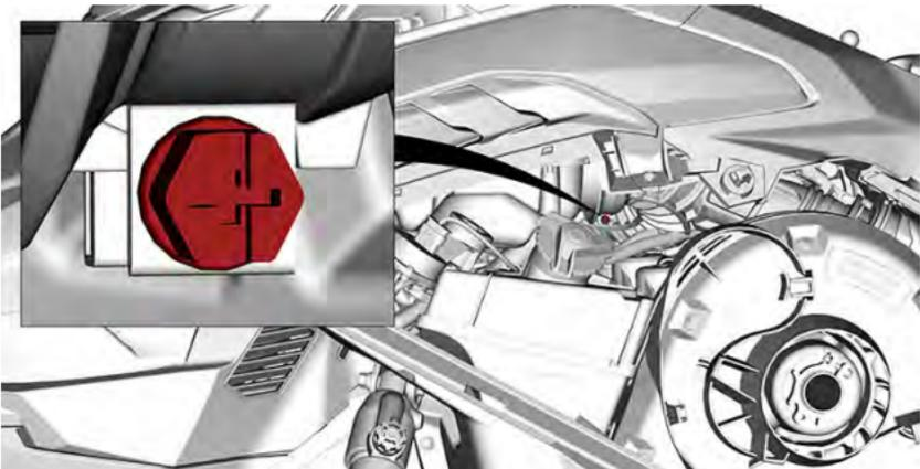
5. Rimuovere le viti di bloccaggio sul modulo superiore della carrozzeria.
