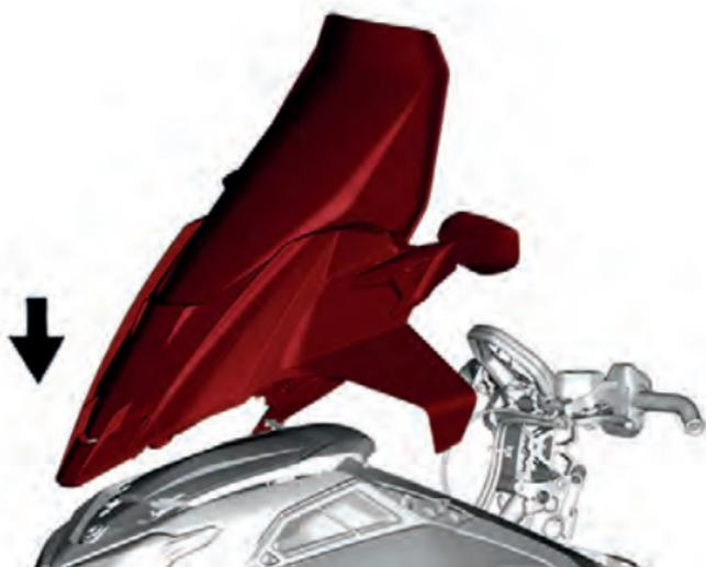
2. Abaissez le pare-brise jusqu'à ce que les cabillots soient insérés dans leur logement.
