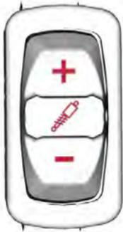
Il permet d'augmenter ou de diminuer la pression d'air de la suspension. Voir les informations détaillées dans *Réglage du véhicule*.
