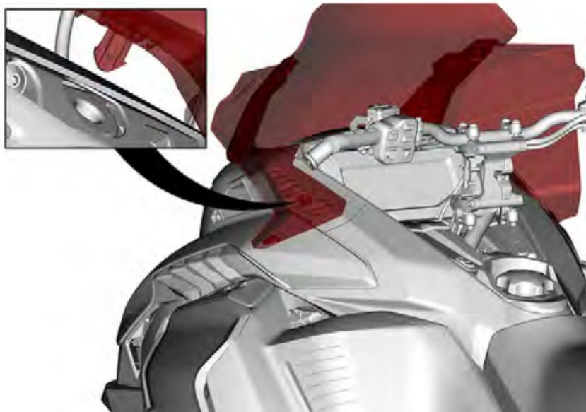
5. Saisissez le pare-brise sous les côtés du support de pare-brise. Soulevez les deux côtés du pare-brise jusqu'à ce que les cabillots latéraux soient dégagés de leurs logements.
