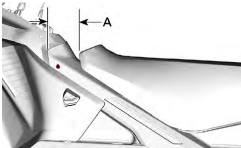
A = Juste assez pour désengager le siège du réservoir de carburant.
