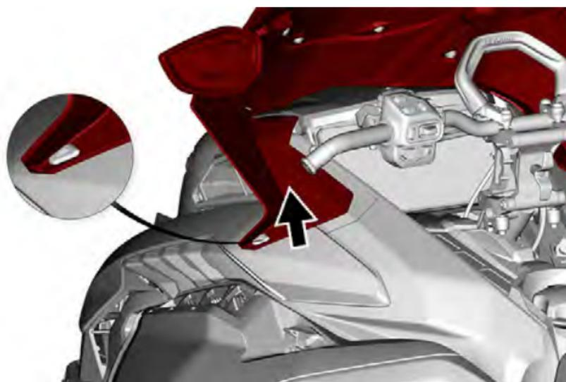
9. Saisissez le pare-brise sous les côtés du support de pare-brise. Soulevez les deux côtés du pare-brise jusqu'à ce que les cabillots latéraux soient dégagés de leurs logements.
