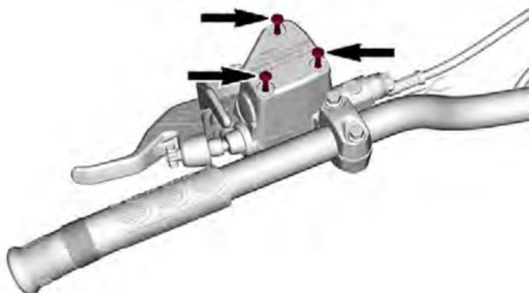
3. Retirez le bouchon de réservoir.
