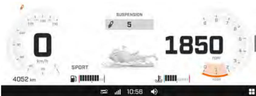
4. Utilisez l'écran tactile ou le bouton haut/bas du commutateur multifonction pour modifier le niveau de suspension.
