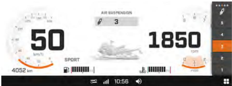
7. Utilisez l'écran tactile ou le bouton haut/bas du commutateur multi-fonction pour modifier le niveau de suspension.
