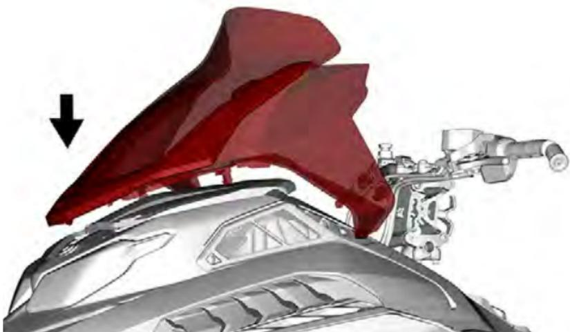
5. Abaissez les deux côtés du pare-brise jusqu'à ce que les cabillots latéraux soient fixés dans leur logement.
