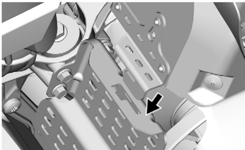
2. Poussez le protège-courroie d'entraînement vers l'avant du moteur pour vers l'avant du véhicule.
