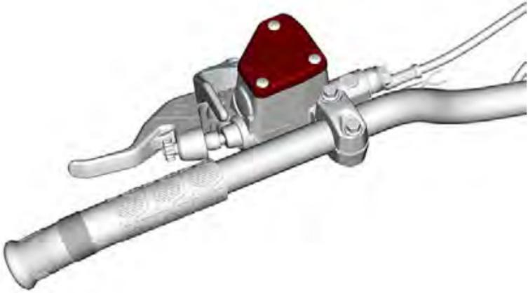
2. Entfernen Sie die Halteschrauben des Behälterdeckels.
