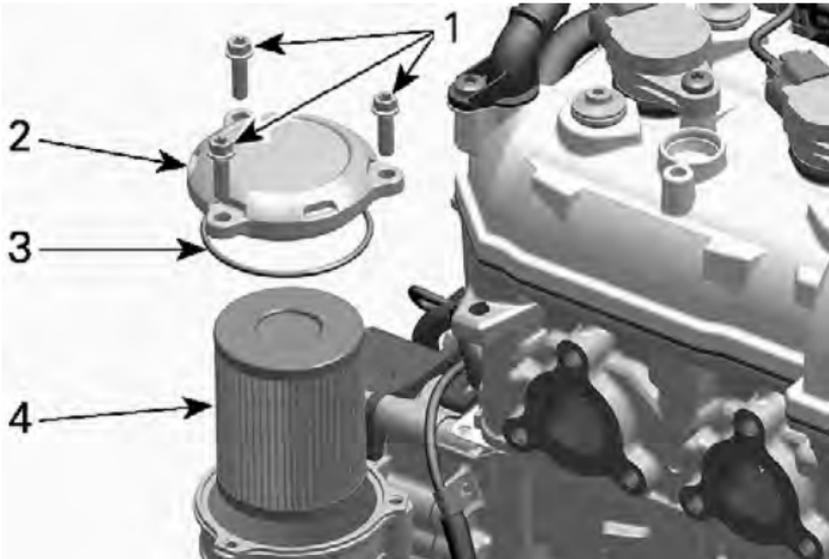
1. Schrauben der Ölfilterabdeckung
