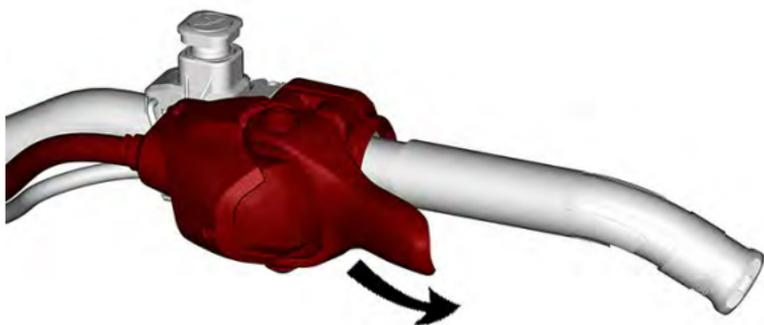
**GASHEBELPOSITION FÜR DAUMENBETÄTIGUNG: ZUM DREHEN DES GASHEBELGEHÄUSES NACH UNTEN DRÜCKEN**
