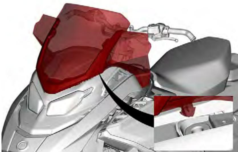
6. Greifen Sie Windschutzscheiben-Halterung an der Vorderseite der Windschutzscheiben-Baugruppe. Heben Sie den vorderen
