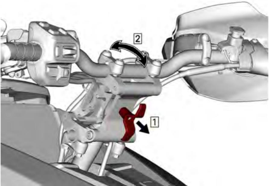
*Schritt 1. Hebel ziehen*
