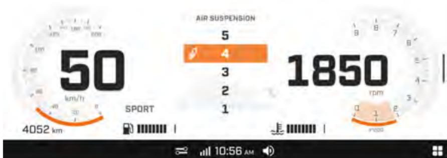
**Ändern Sie die Federungsstufe mithilfe der Fahreinstellungstaste**
