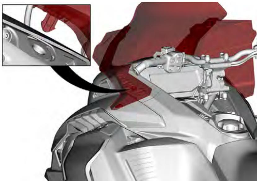
5. Greifen Sie die Windschutzscheiben-Baugruppe unter den Seiten der Windschutzscheiben-Halterung. Heben Sie beide Seiten der Windschutzscheiben-Baugruppe an, bis sich die seitlichen Verankerungsstifte aus ihren Halterungen lösen.
