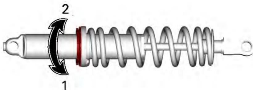
1. Vorspannung erhöhen
