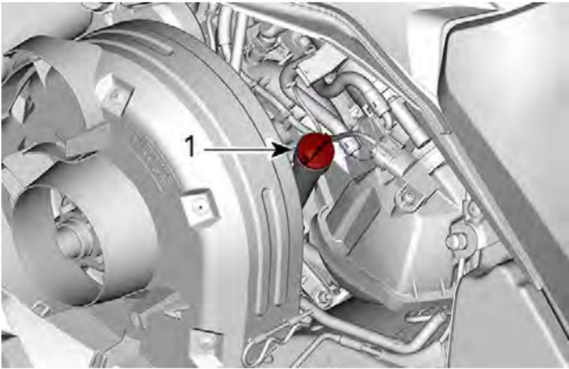
**LINKE SEITE DES FAHRZEUGS****1. Öltank-Messstab**
