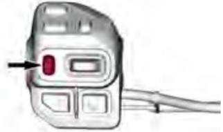
2. Verwenden Sie die Taste *Tageskilometer/Hinauf*, um die Leistung zu steigern, und die Taste *Modus/Hinab*, um sie zu reduzieren.
