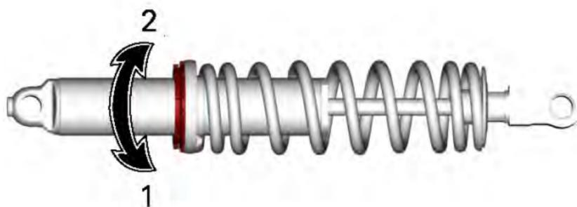
1. Vorspannung erhöhen
