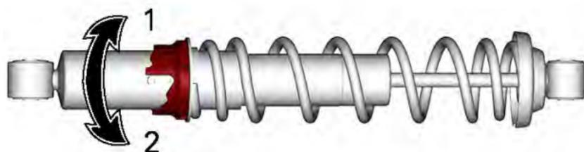
1. Vorspannung erhöhen
