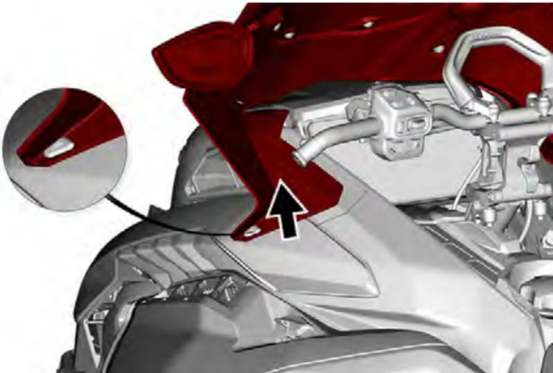
9. Greifen Sie die Windschutzscheiben-Baugruppe unter den Seiten der Windschutzscheiben-Halterung. Heben Sie beide Seiten der Windschutzscheiben-Baugruppe an, bis sich die seitlichen Verankerungsstifte aus ihren Halterungen lösen.
