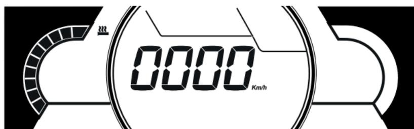
Die Einstellstufen des Gashebels werden über die Temperaturanzeige angezeigt und blinken bei Auswahl.
