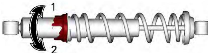
1. Vorspannung erhöhen
