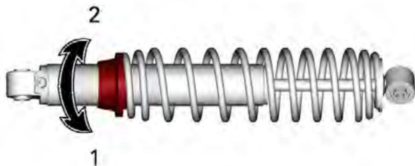
1. Vorspannung erhöhen
