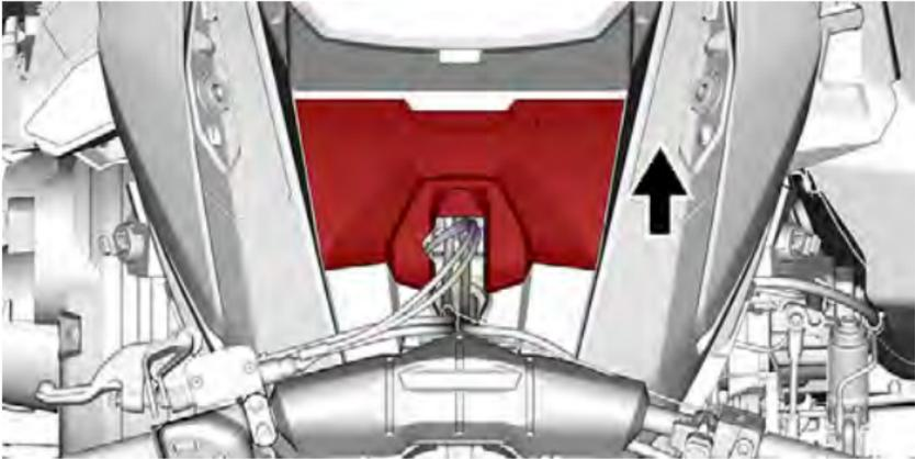
6. Montieren Sie beide Seitenverkleidungen.
