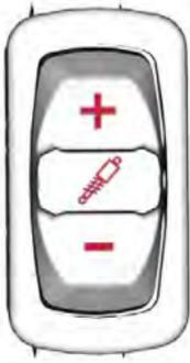
Der Federungsschalter wird verwendet, um den Luftdruck zu steigern oder zu reduzieren. Weitere Einzelheiten hierzu finden Sie unter *Einstellungen an Ihrem Fahrzeug* vornehmen.
