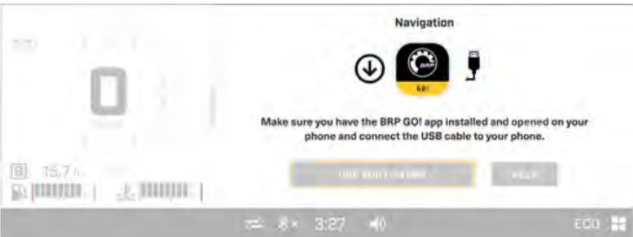
Wenn eine oder mehrere Karten direkt auf das 10,25 Zoll Touchscreen-Farbdisplay heruntergeladen werden, können Sie mit der Option „Integriertes GPS verwenden“ darauf
