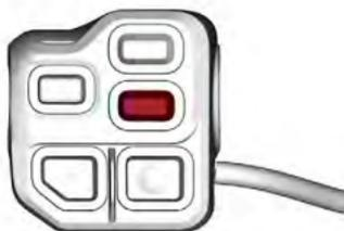
2. Verwenden Sie die Taste *Tageskilometer/Hinauf*, um die Leistung zu steigern, und die Taste *Modus/Hinab*, um sie zu reduzieren.
