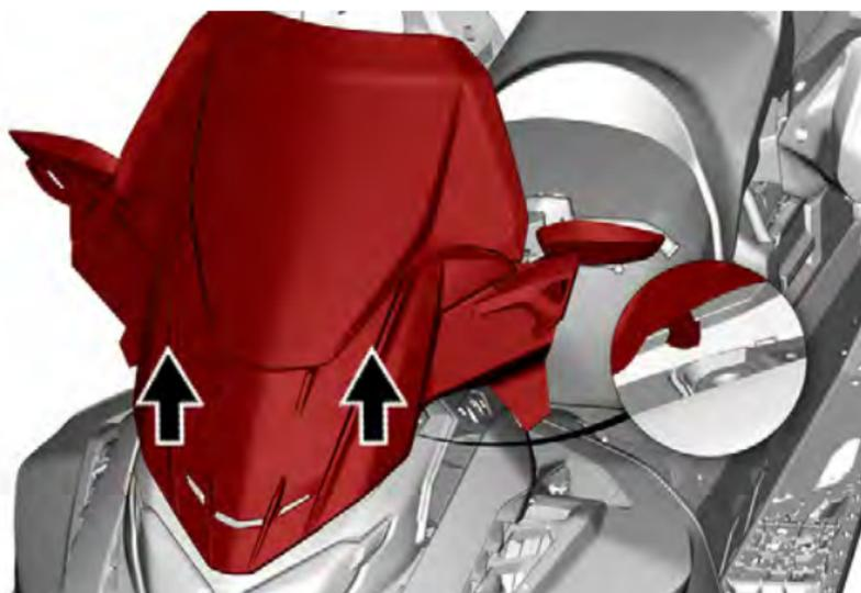
10. Greifen Sie Windschutzscheiben-Halterung durch den Lüftungsschlitz vorne an der Baugruppe. Heben Sie den vorderen Verankerungsstift aus seiner Halterung und nehmen Sie die Windschutzscheiben-Baugruppe ab.
