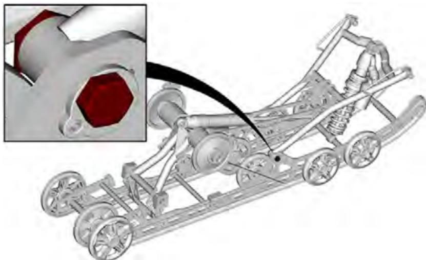
6. Rimuovere la camma, ruotare di 180° e reinstallare nel binario.
