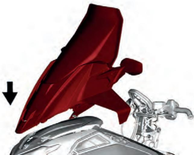
2. Abbassare il gruppo del parabrezza fino a quando i montanti di ancoraggio sono inseriti nelle loro sedi.
