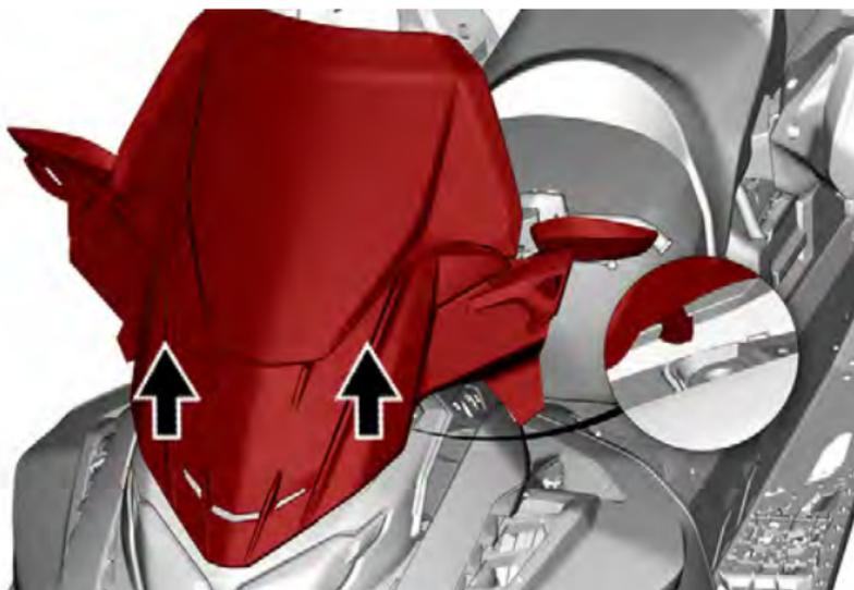
10. Afferrare il supporto del parabrezza attraverso la fessura di ventilazione nella parte anteriore del gruppo. Sollevare il montante di ancoraggio anteriore dalla sua sede e rimuovere il gruppo del parabrezza.
