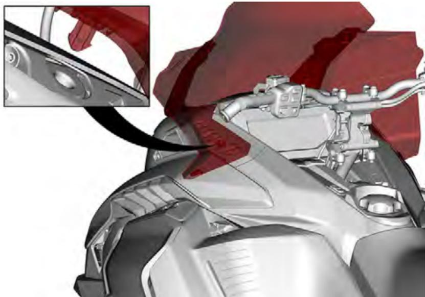
5. Afferrare il gruppo del parabrezza sotto i lati del supporto del parabrezza. Sollevare entrambi i lati del gruppo del parabrezza fino a quando i montanti di ancoraggio laterali sono liberi dalle loro sedi.
