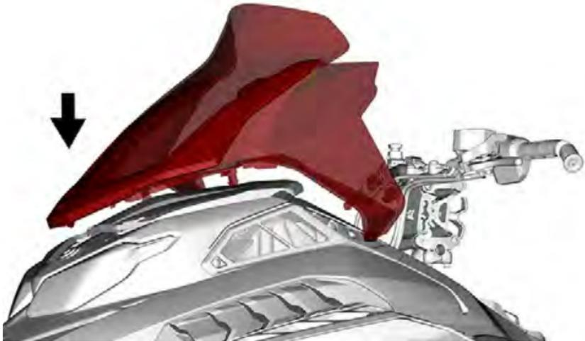
5. Abbassare entrambi i lati del gruppo del parabrezza fino a quando i montanti di ancoraggio laterali sono fissati nelle loro sedi.
