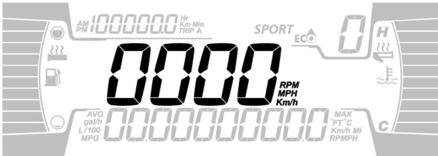
Visualizza il numero di giri del motore o la velocità del veicolo in KM/h o in MPH.
