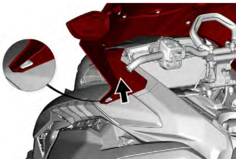
9. Afferrare il gruppo del parabrezza sotto i lati del supporto del parabrezza. Sollevare entrambi i lati del gruppo del parabrezza fino a quando i montanti di ancoraggio laterali sono liberi dalle loro sedi.
