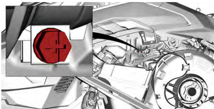
5. Retirez les vis de fixation du module de carrosserie supérieur.
