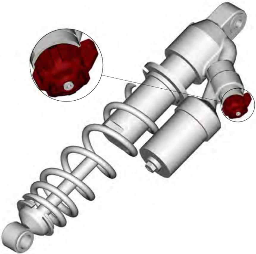
***BOUON DE RÉGLAGE DE L'AMORTISSEMENT EN COMPRESSION À 3 POSITIONS***
