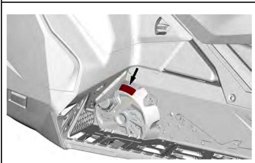
**Capacité de charge maximale - Étiquette d'avertissement**
