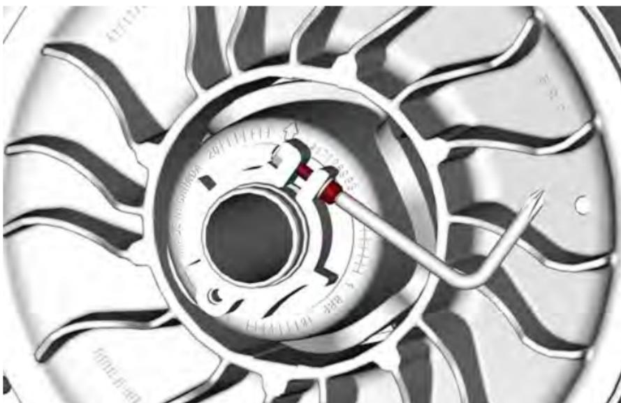
6. Utilizzando lo strumento di regolazione delle sospensioni fornito nel kit degli attrezzi, girare l'anello di regolazione di 1/4 di giro alla volta, quindi ruotare la puleggia condotta per installare correttamente la cinghia tra le gole della puleggia.
