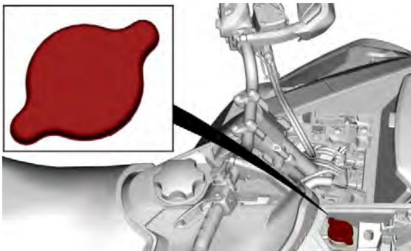
7. Se il livello del liquido refrigerante continua a diminuire durante o dopo ogni corsa, o se è necessario rabboccare l'intero impianto, rivolgersi a un concessionario autorizzato di motoslitte BRP, a un'officina o a un professionista di fiducia per la manutenzione.
