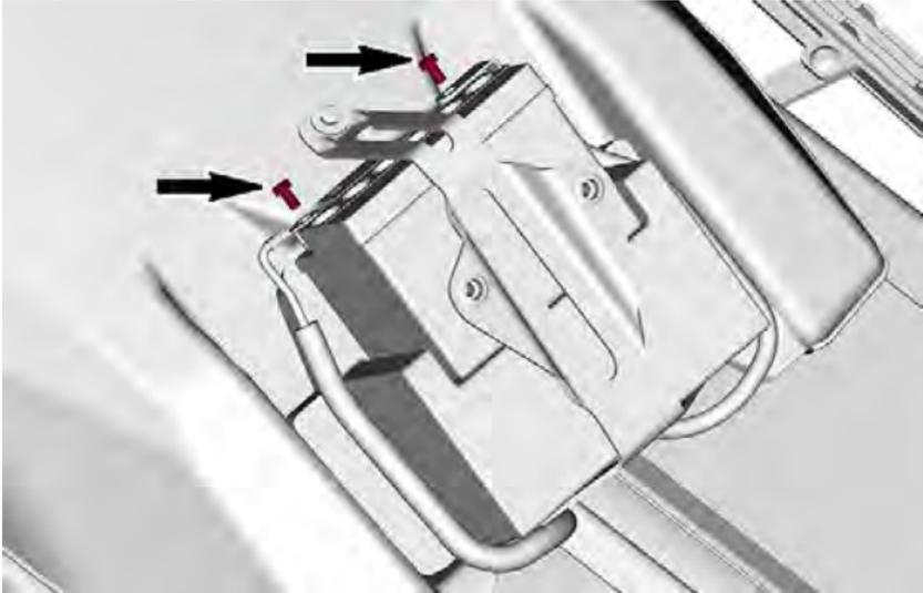
4. Rimuovere la staffa di serraggio della batteria.
