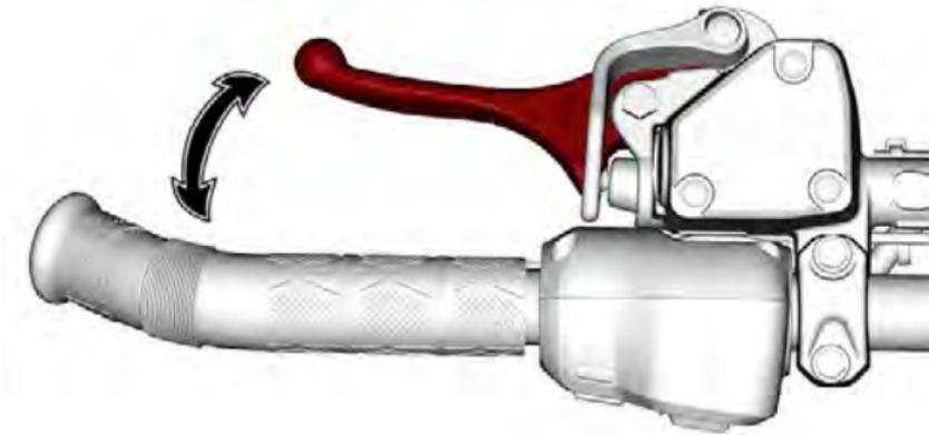
**TIPICO****Leva acceleratore regolabile (se in dotazione)**
