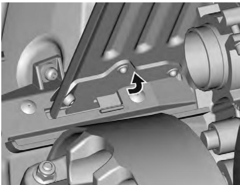
3. Posizionare la parte posteriore della protezione cinghia di trasmissione sopra il fermo e assicurarla mediante il fermo perno.
