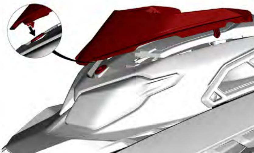
2. Abbassare la parte posteriore del parabrezza e inserire i montanti di ancoraggio laterali nelle rispettive sedi. Premere verso il basso finché i montanti non scattano in posizione.
