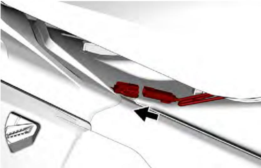
3. Scorrere in avanti il sedile per agganciarlo con le linguette di fissaggio.
