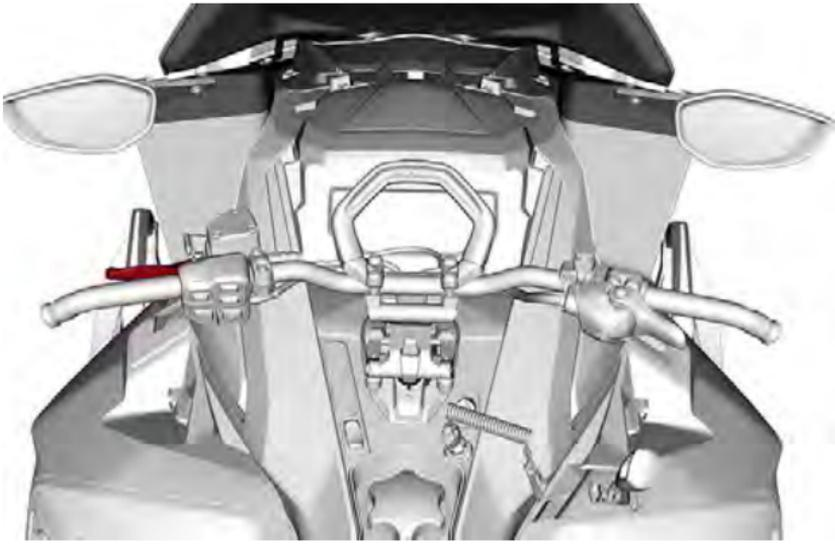
Quando viene premuta, vengono azionati i freni. Una volta rilasciata, la leva torna automaticamente in posizione di riposo. L'effetto della frenata è proporzionale alla pressione applicata sulla leva, al tipo di terreno e alla quantità di neve che lo ricopre.
