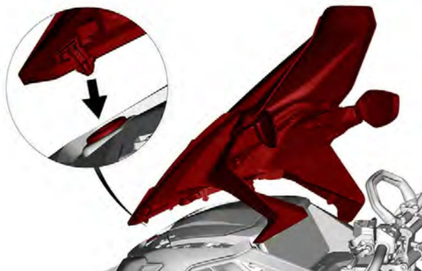
2. Abbassare la parte posteriore del parabrezza e inserire i montanti di ancoraggio laterali nelle rispettive sedi. Premere verso il basso finché i montanti non scattano in posizione.
