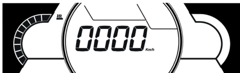
I livelli di regolazione della leva dell'acceleratore sono visualizzati tramite l'indicatore di temperatura e lampeggiano quando vengono selezionati.
