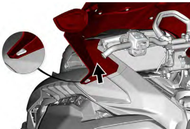
2. Afferrare il gruppo del parabrezza sotto i lati del supporto del parabrezza. Sollevare entrambi i lati del gruppo del parabrezza fino a quando i montanti di ancoraggio laterali sono liberi dalle loro sedi.
