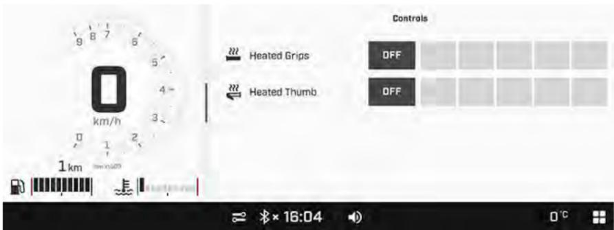
È possibile regolare all'intensità desiderata i livelli del calore delle manopole riscaldate e della leva dell'acceleratore.
