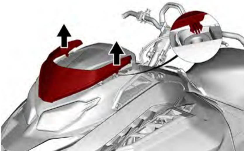
2. Afferrare il supporto del parabrezza attraverso la fessura di ventilazione nella parte anteriore del gruppo. Sollevare il gruppo del parabrezza per liberare il montante di ancoraggio anteriore dalla sua sede. Rimuovere il gruppo del parabrezza.
