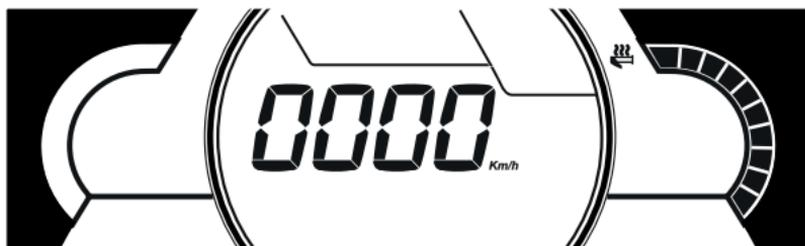
2. Aumentare gradualmente l'intensità del calore utilizzando il pulsante Su/Contachilometri. Una pressione breve aumenta il calore di un livello. Tenendo premuto il pulsante Su/Trip, il calore viene automaticamente impostato al massimo.
