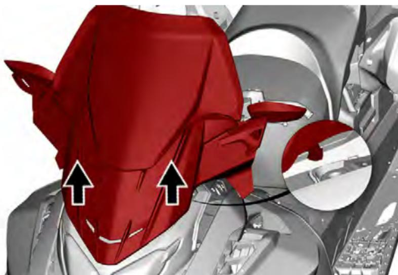
3. Afferrare il supporto del parabrezza attraverso la fessura di ventilazione nella parte anteriore del gruppo. Sollevare il montante di ancoraggio anteriore dalla sua sede e rimuovere il gruppo del parabrezza.
