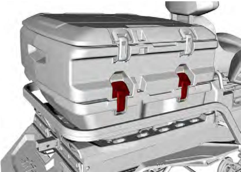
Fissare il baule facendo ruotare le leve LinQ in fondo al baule in senso orario.
