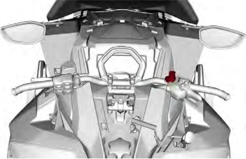
Per arrestare il motore in caso di emergenza, premere l'interruttore verso il basso in posizione OFF e simultaneamente azionare il freno.
