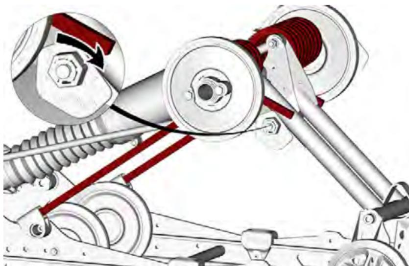
**EINSTELLUNG FEDERVORSPANNUNG LINKS – TYPISCH**
