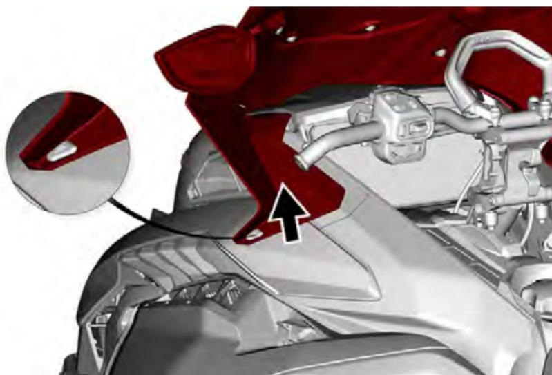
2. Greifen Sie die Windschutzscheiben-Baugruppe unter den Seiten der Windschutzscheiben-Halterung. Heben Sie beide Seiten der Windschutzscheiben-Baugruppe an, bis sich die seitlichen Verankerungsstifte aus ihren Halterungen lösen.
