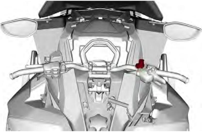
Um den Motor in einem Notfall anzuhalten, drücken Sie den Schalter herunter in die AUS-Stellung und betätigen Sie gleichzeitig die Bremse.
