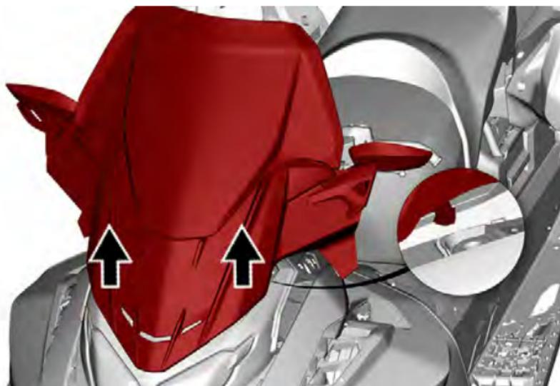
3. Greifen Sie Windschutzscheiben-Halterung durch den Lüftungsschlitz vorne an der Baugruppe. Heben Sie den vorderen Verankerungsstift aus seiner Halterung und nehmen Sie die Windschutzscheiben-Baugruppe ab.
