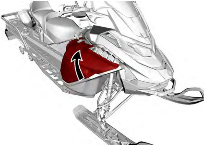
3. Sichern Sie die Seitenverkleidung mit den Verriegelungen.
