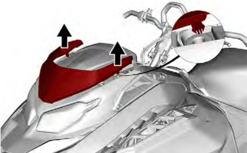
2. Greifen Sie Windschutzscheiben-Halterung durch den Lüftungsschlitz vorne an der Baugruppe. Heben Sie die Windschutzscheiben-Baugruppe, um den vorderen
