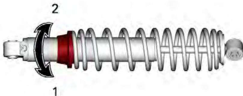
1. Vorspannung erhöhen
