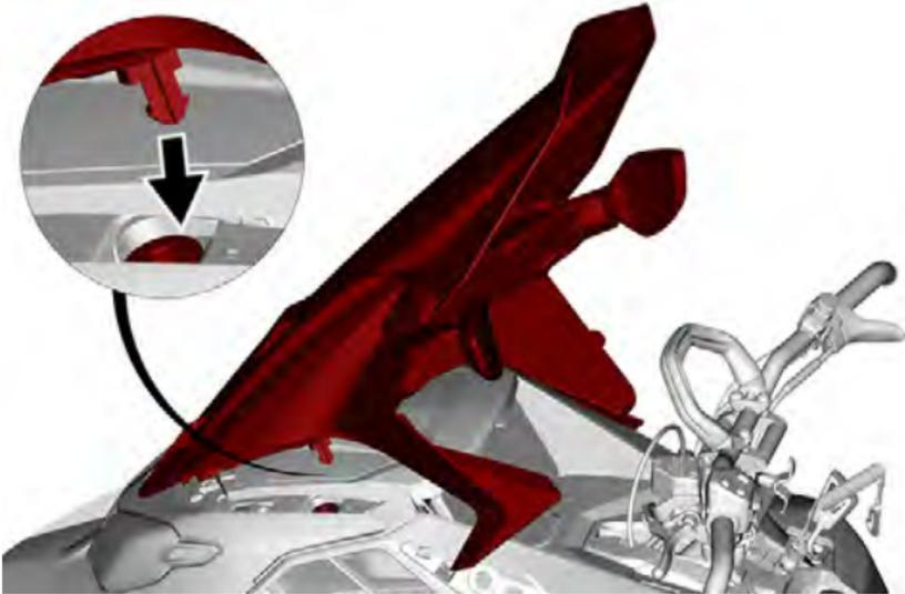
3. Drücken Sie die hinteren Kanten der Windschutzscheiben-Halterung auf die Gummihaltebolzen.
