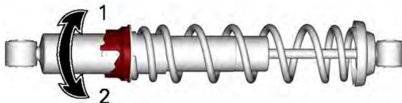
1. Vorspannung erhöhen
