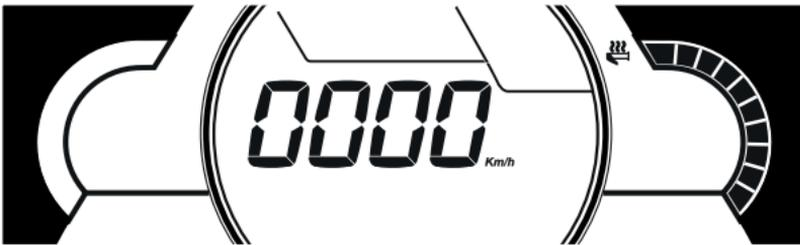
2. Erhöhen Sie die Heizintensität allmählich mit der Taste Nach oben/Tageskilometer. Durch einmaliges kurzes Drücken wird die Heizintensität um eine Stufe erhöht. Halten Sie die Taste Nach oben/Tageskilometer gedrückt, um die Heizintensität automatisch auf die höchste Stufe einzustellen.
