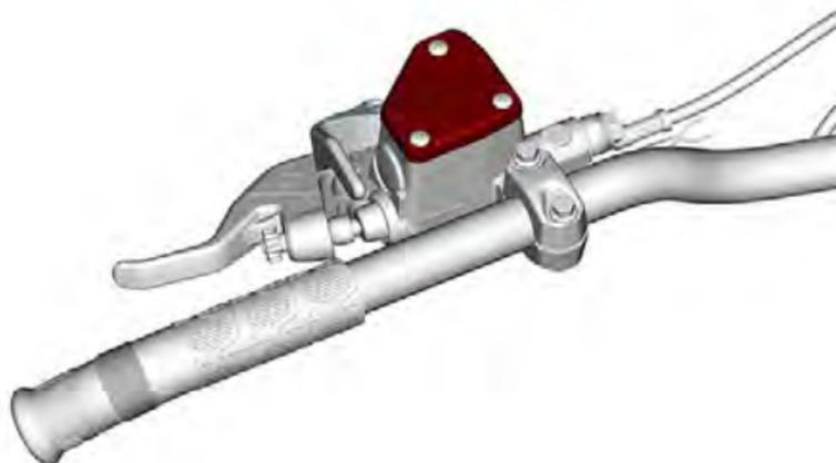
2. Entfernen Sie die Halteschrauben des Behälterdeckels.
