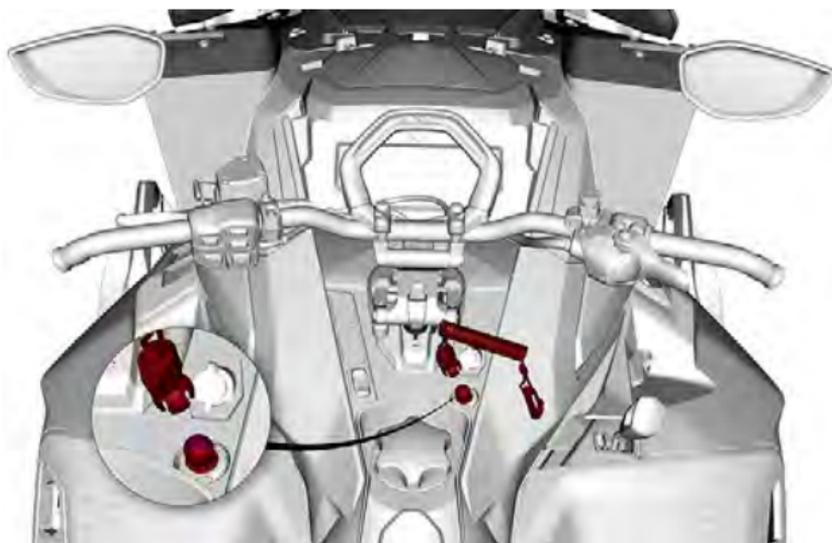
Der Motor-aus-Schalter (Sicherheitsleine) befindet sich an der Konsole.
