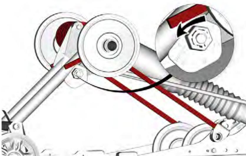
**EINSTELLUNG FEDERVORSPANNUNG RECHTS – TYPISCH**
