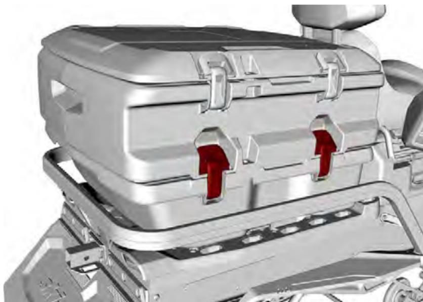
Befestigen Sie die Transportbox, indem Sie die LinQ-Hebel am Boden der Transportbox im Uhrzeigersinn drehen.
