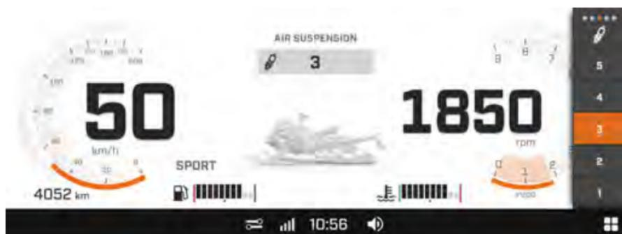
7. Verwenden Sie den Berührungsbildschirm oder die Pfeiltasten Nach oben/Nach unten des Multifunktionsschalters, um die Federungsstufe zu ändern.
