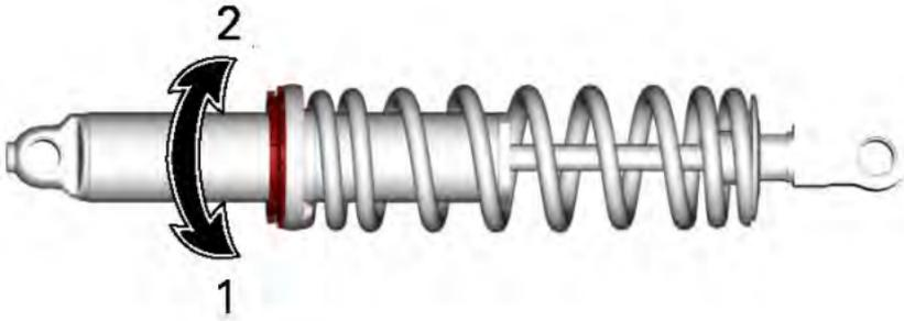
1. Vorspannung erhöhen
