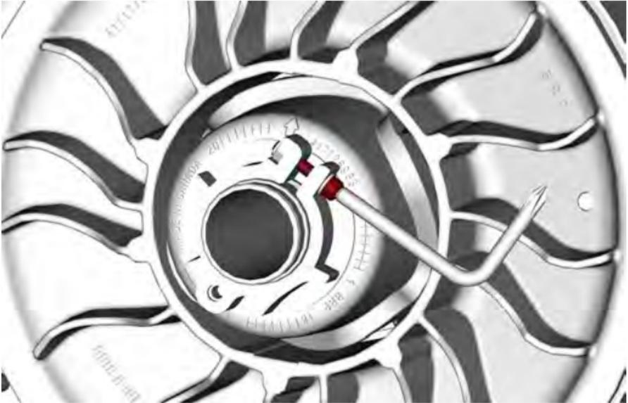
2. Drehen Sie den Einstellring mit der im Werkzeugsatz enthaltenen Vorrichtung zur Einstellung der Aufhängung jeweils um eine Viertelumdrehung und drehen Sie dann die Abtriebsscheibe, damit der Riemen zwischen den Scheiben den richtigen Sitz findet.
