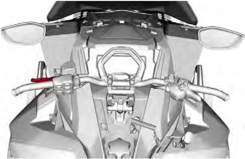
Wenn Sie ihn anziehen, wird die Bremse betätigt. Wenn er losgelassen wird, kehrt er automatisch wieder in die Ruhestellung zurück. Die Bremswirkung ist proportional zum auf den Hebel ausgeübten Druck und abhängig von der Art des Geländes und der Schneedecke.
