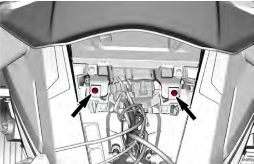
5. Lösen Sie die Schraube und Unterlegscheibe, die die Haubenverkleidung fixieren.
