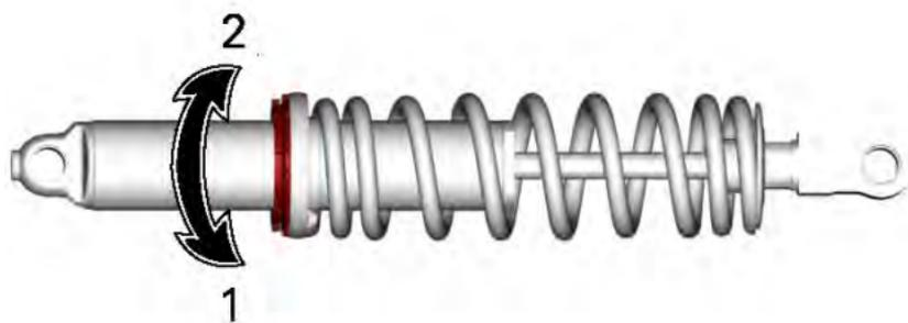
1. Vorspannung erhöhen
