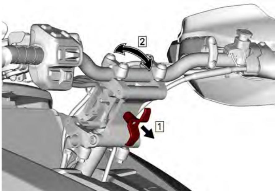
Schritt 1. Hebel ziehen
