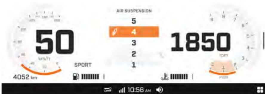
**Ändern Sie die Federungsstufe mithilfe der Fahreinstellungstaste**
