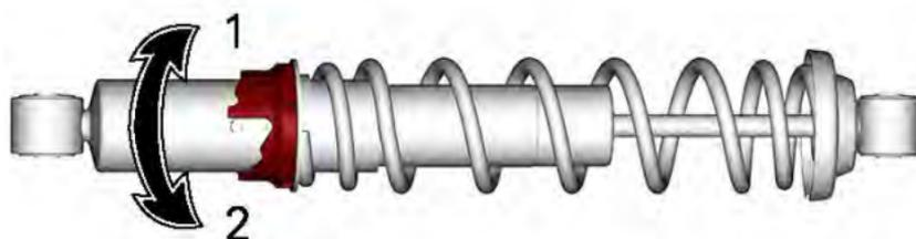
1. Vorspannung erhöhen
