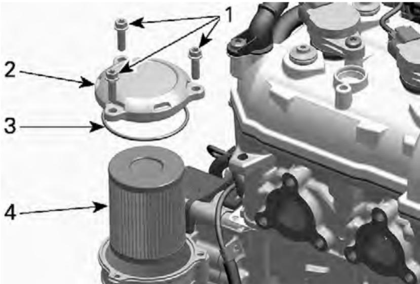
1. Schrauben der Ölfilterabdeckung
