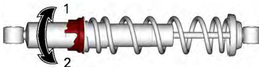
1. Vorspannung erhöhen
