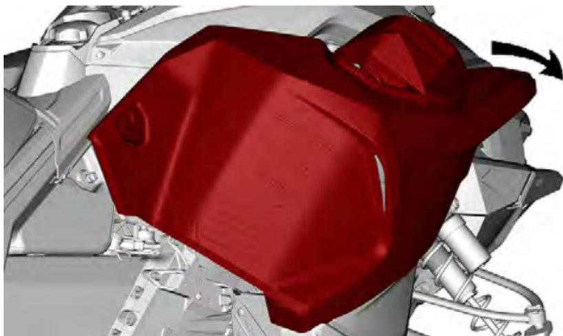
2. Um die Laschen zu lösen, heben Sie die Seitenverkleidung.
