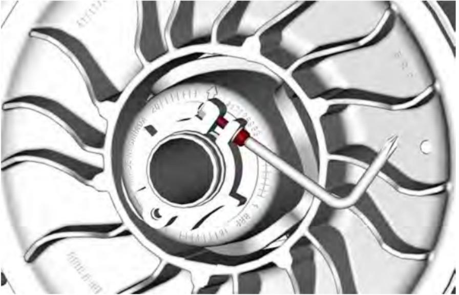
5. Drehen Sie den Einstellring mit der im Werkzeugsatz enthaltenen Vorrichtung zur Einstellung der Aufhängung jeweils um eine Viertelumdrehung und drehen Sie dann die Abtriebscheibe, damit der Riemen zwischen den Scheiben den richtigen Sitz findet.
