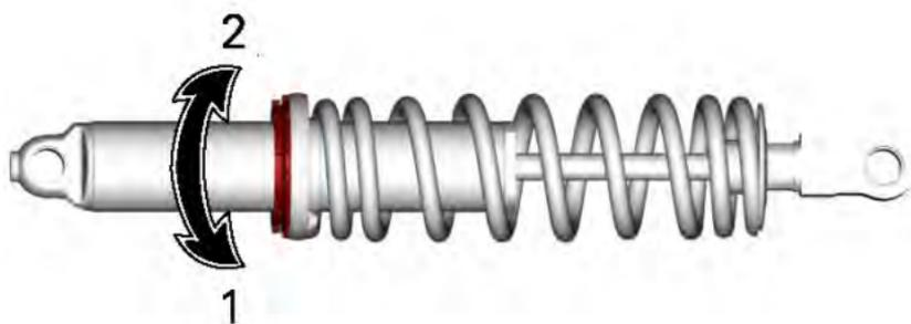
1. Vorspannung erhöhen
