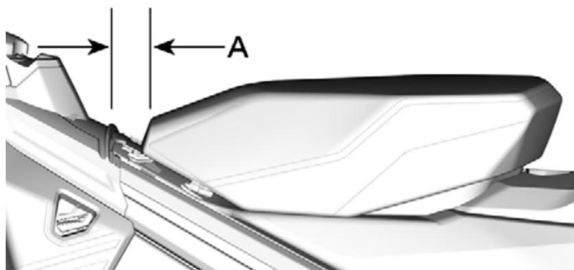
A. Quanto basta per disinnestare il sedile dal serbatoio del carburante
