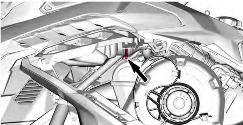
7. Per rimuovere il modulo superiore della carrozzeria, afferrarlo nell'area di supporto del quadro strumenti e spingerlo verso in avanti.
