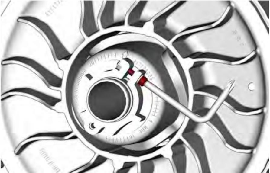
5. Utilizzando lo strumento di regolazione delle sospensioni fornito nel kit degli attrezzi, girare l'anello di regolazione di 1/4 di giro alla volta, quindi ruotare la puleggia condotta per installare correttamente la cinghia tra le gole della puleggia.
