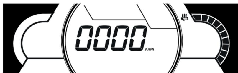
2. Aumentare gradualmente l'intensità del calore utilizzando il pulsante Su/Contachilometri. Una pressione breve aumenta il calore di un livello. Tenendo premuto il pulsante Su/Trip, il calore viene automaticamente impostato al massimo.
