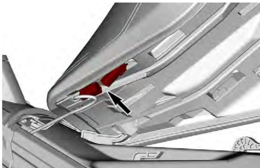
2. Posizionare il sedile sulle linguette di blocco, quindi farlo scorrere in avanti finché la linguetta si blocca sopra il gancio anteriore.
