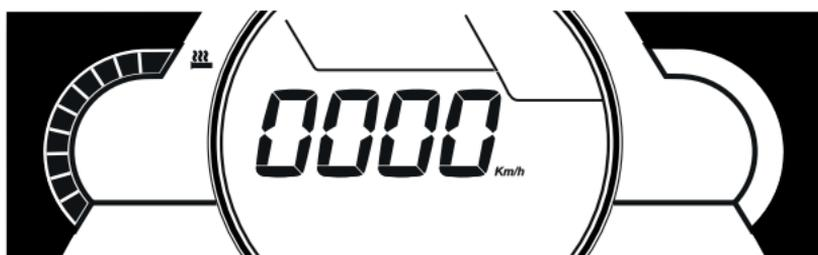
I livelli di regolazione della leva dell'acceleratore sono visualizzati tramite l'indicatore di temperatura e lampeggiano quando vengono selezionati.
