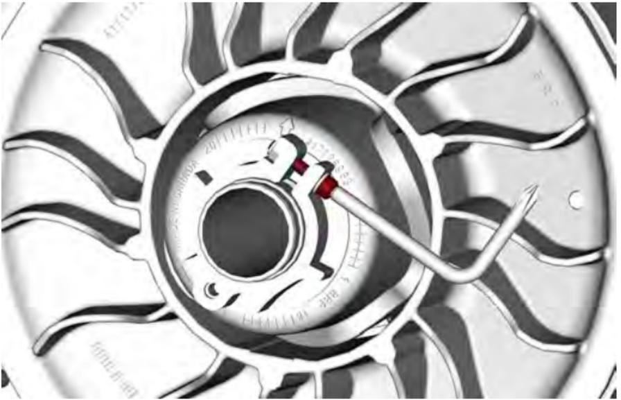
2. Drehen Sie den Einstellring mit der im Werkzeugsatz enthaltenen Vorrichtung zur Einstellung der Aufhängung jeweils um eine Viertelumdrehung und drehen Sie dann die Abtriebscheibe, damit der Riemen zwischen den Scheiben den richtigen Sitz findet.
