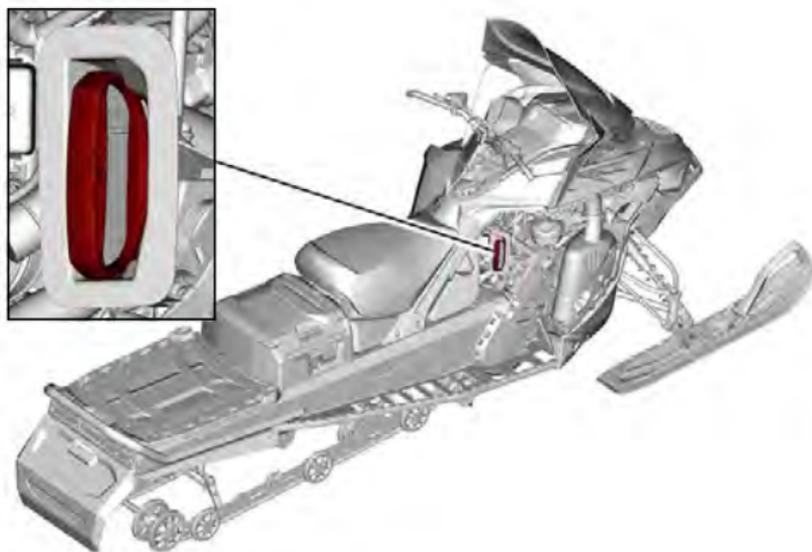
Hierbei handelt es sich um einen Startergriff mit automatischer Aufwicklung, der sich auf der rechten Seite des Motorschlittens unter der Seitenabdeckung befindet. Öffnen Sie das rechte Seitenteil, um auf den Rückholgriff zugreifen zu können. Siehe *Seitenabdeckungen ausbauen* in diesem Unterabschnitt. Zum Betätigen des Mechanismus ziehen Sie langsam am Griff bis Sie einen Widerstand spüren. Ziehen Sie dann energisch und kraftvoll. Geben Sie den Griff langsam wieder frei.
