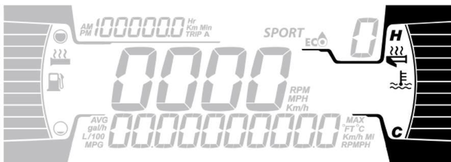
Die beheizten Griffe und der Gashebel sind ausgeschaltet, wenn keine Balken auf der Anzeige angezeigt werden.
