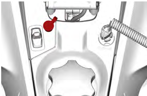
CONDUCTEUR - EMBLACEMENT PRISE DE VISIÈRE ÉLECTRIQUE
