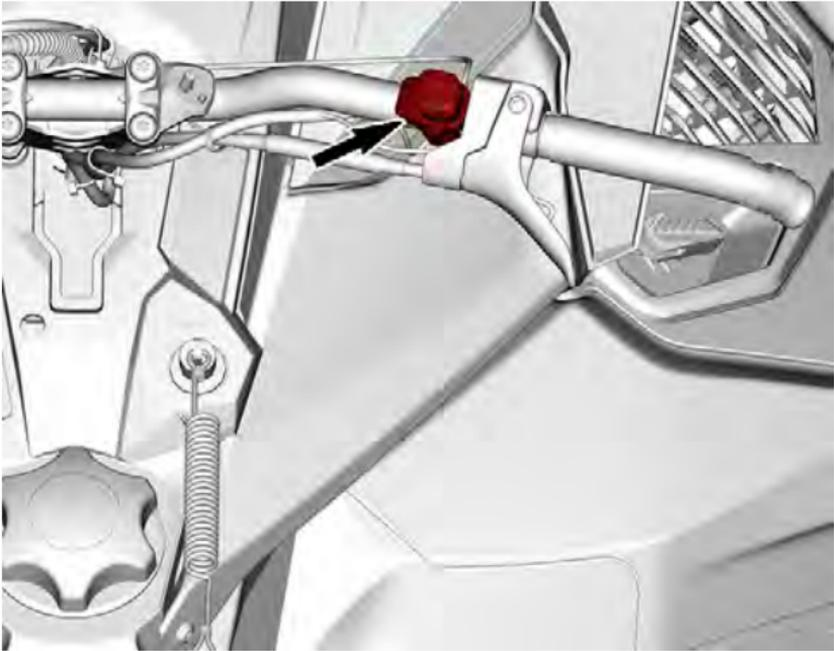
Per arrestare il motore in caso di emergenza, premere l'interruttore verso il basso in posizione OFF e simultaneamente azionare il freno.
