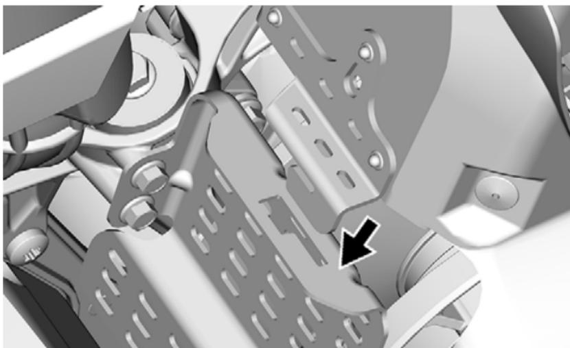
2. Spingere la protezione della cinghia di trasmissione verso il motore e poi verso il davanti del veicolo.
