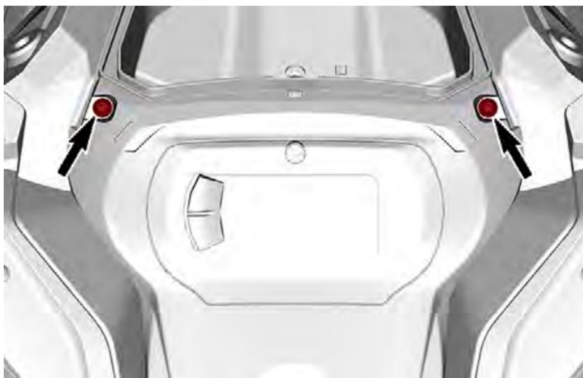
4. Sollevare la parte anteriore del supporto dell'indicatore, quindi farlo scivolare in avanti per rimuoverlo.
