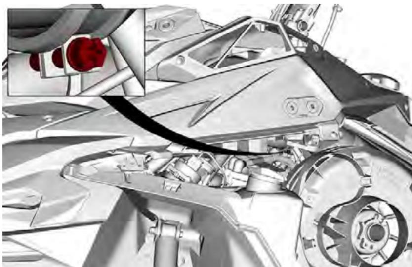
4. Rimuovere le viti di bloccaggio sul modulo superiore della carrozzeria.
