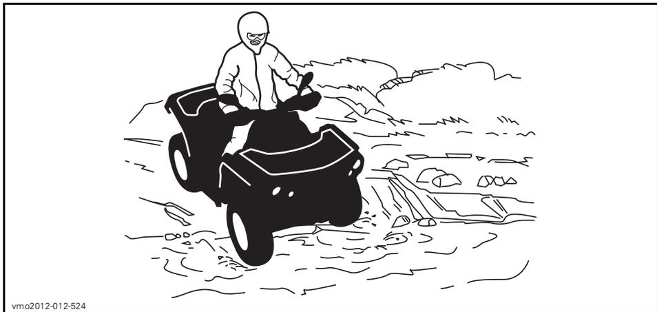
Des freins mouillés réduisent la capacité de freinage. Après être sorti de l'eau, de la neige ou de la boue, actionner les freins quelques fois pour que la chaleur de la friction sèche les plaquettes. Prévoir davantage de distance pour freiner.
