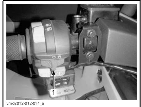
1. Interrupteur d'arrêt d'urgence du moteur
