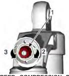
HIGH-SPEED COMPRESSION DAMPING (USE A 17-MM WRENCH)
