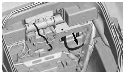
DC12 - CIRCUITO DELANTERO PARA ACCESORIOS DEL CLIENTE - TRAS EL COMPARTIMENTO DE ALMACENAMIENTO TRASERO
