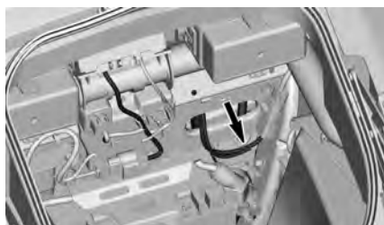
DC12 – ETUMAINEN JOHDOTUS LISÄVARUSTEILLE – TAVARATILAN TAKANA 2. Sivuhuoltokannen takana.
