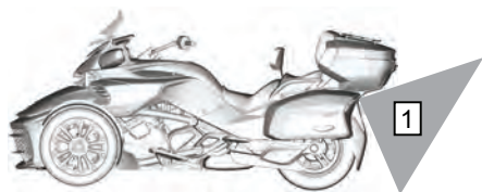
1. Cône de vision approximatif de la caméra arrière
