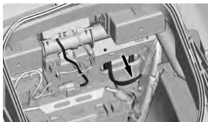
DC12 - CIRCUIT D'ACCESSOIRES AVANT - DERRIÈRE LE COMPARTIMENT DE RANGEMENT
