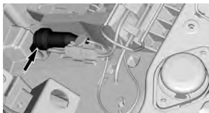
DC56 - CIRCUIT D'ACCESSOIRES ARRIÈRE - SOUS LE SIÈGE DU PASSAGER
