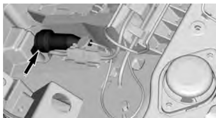
DC56 - CIRCUITO ACCESSORIO DEL CLIENTE POSTERIORE - SOTTO IL SEDEILE DEL PASSEGGERO
