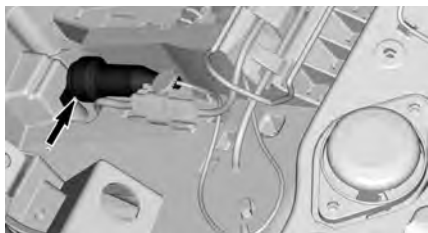
DC56 - BAKRE KUNDE TILBEHØRSPANEL - UNDER PASSASJERSETET
