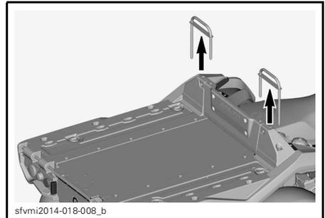
3. Placer la paroi latérale sur la plate-forme à plat et l'abaisser à sa place.
