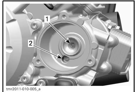
1. Orifice de sortie allant au système d'approvisionnement en huile du moteur
