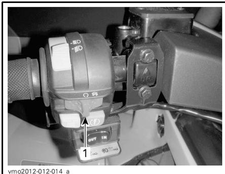
1. Interrupteur d'arrêt d'urgence du moteur
