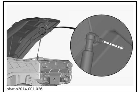
2. Détacher l'extrémité inférieure en enlevant l'écrou.
