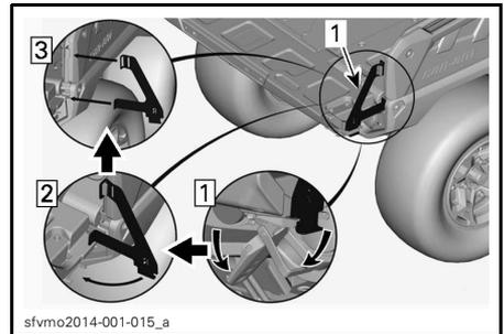
**1. Support côté droit****Installation de la rallonge du hayon****1. Placer les supports au hayon.**
