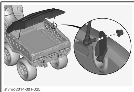
9. Installer l'extrémité supérieur de l'amortisseur en le vissant en place.
