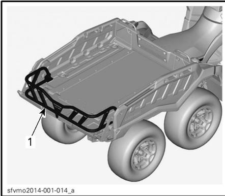
**1. Extension de chargement****1. Retirer les appareils de fixation de l'extension de hayon.**
