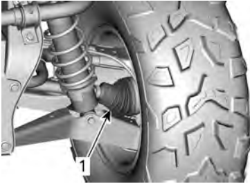
1. Äußerer Faltenbalg der Antriebswelle
