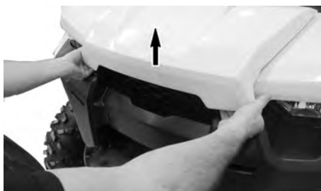
LEVER LE BORD DU COUVERCLE D'ENTRETIEN AVANT.
