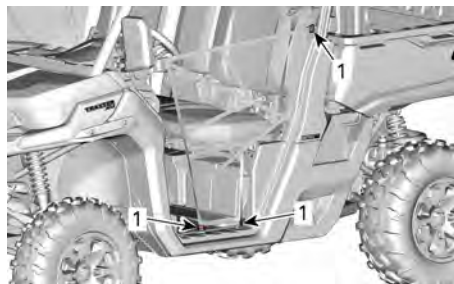
1. Posizione delle regolazioni per le protezioni laterali
