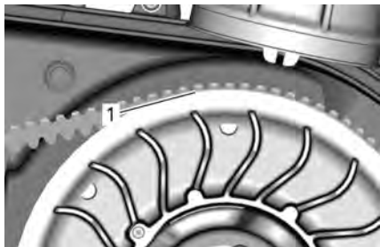
1. Parte inferiore degli ingranaggi a livello con il bordo della puleggia condotta
