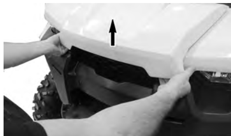
DE RAND VAN HET VOORSTE ONDERHOUDSDEKSEL OPTILLEN.
