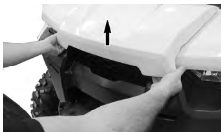
LØFT PÅ KANTEN PÅ SERVICEDEKSELET FORAN.
