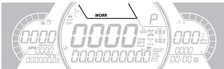
La pantalla para modo del motor indica el tipo de operación seleccionada:
