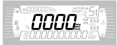
Muestra la velocidad del vehículo en km/h, mph ó r.p.m.
