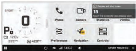
La pantalla táctil se mantiene ENCENDIDA durante una hora después de la última interacción con la pantalla táctil o hasta que el nivel de la batería baje a 11.8 V.
