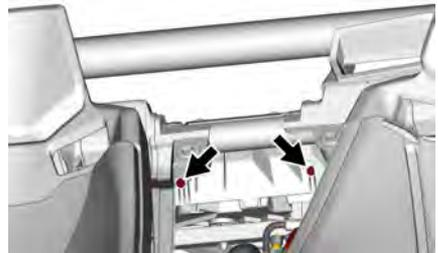
Desconecte la manguera del intercooler.
