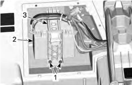
1. Tornillos de sujeción del portabaterías
