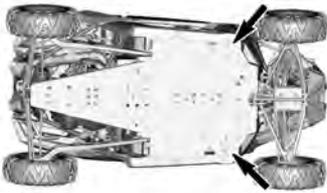
**POSICIONES DEL SOPORTE DEL GATO - PARTE DELANTERA DEL VEHÍCULO**
