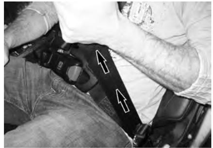
Para aflojar el cinturón, sujete el cinturón del regazo con una mano y tire de la correa roja hacia afuera.
