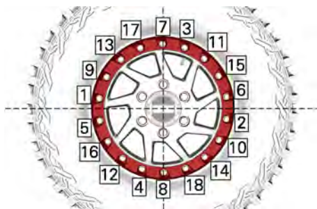
SITUAZIONE TIPICA - SEQUENZA DI SERRAGGIO
