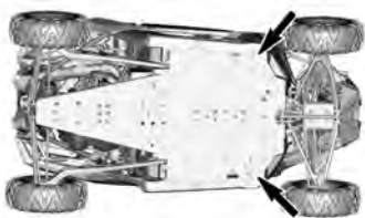
KRIKPOSITIES - VOORKANT VAN HET VOERTUIG
