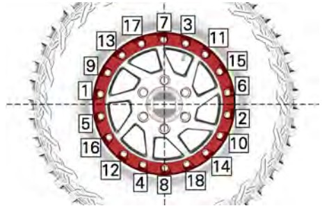
TYPISCH - AANDRAAIVOLGORDE
