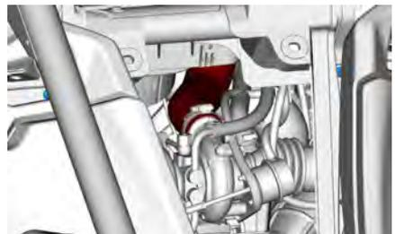
Remova o parafuso para abrir o intercooler e o suporte da mangueira do cárter.
