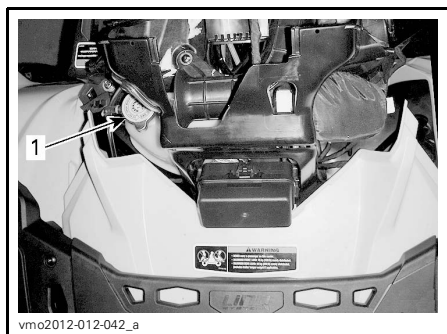
1. Réservoir de liquide de refroidissement
