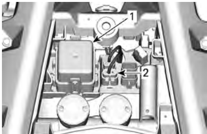
1. Vorderer Sicherungskasten 2. DPS-Sicherung
