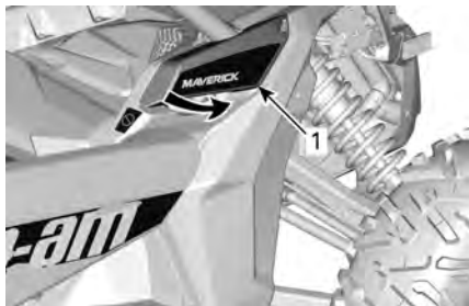
1. Cobertura da tampa do reservatório de combustível
