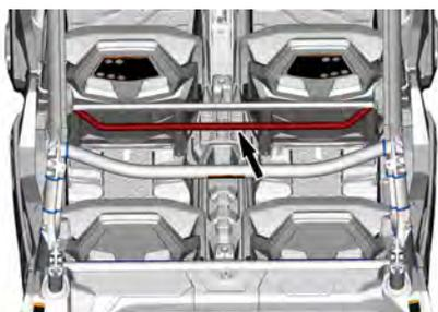
Segurar nas barras de apoio ajuda o passageiro a se equilibrar com o movimento do veículo e ajuda a manter braços e corpo dentro do cockpit em caso de capotamento.
