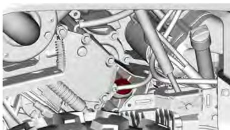
3. Coloque um recipiente de drenagem embaixo do bocal de drenagem do óleo.
