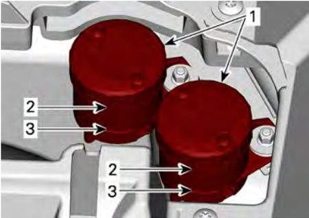
1. Depósitos de líquido de frenos
