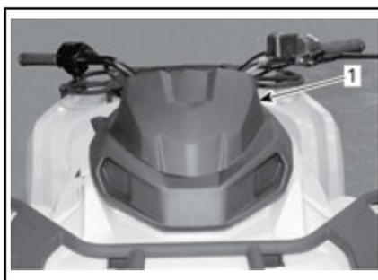
1. Gauge support Suporte do medidor
